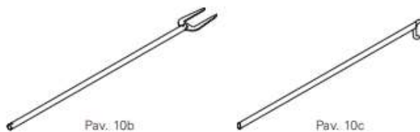
13 pav. Montavimo šakės GT/VT, VT 20 ir GT24 sijoms (b), montavimo šakės 24 GT 24 sijoms (c)
