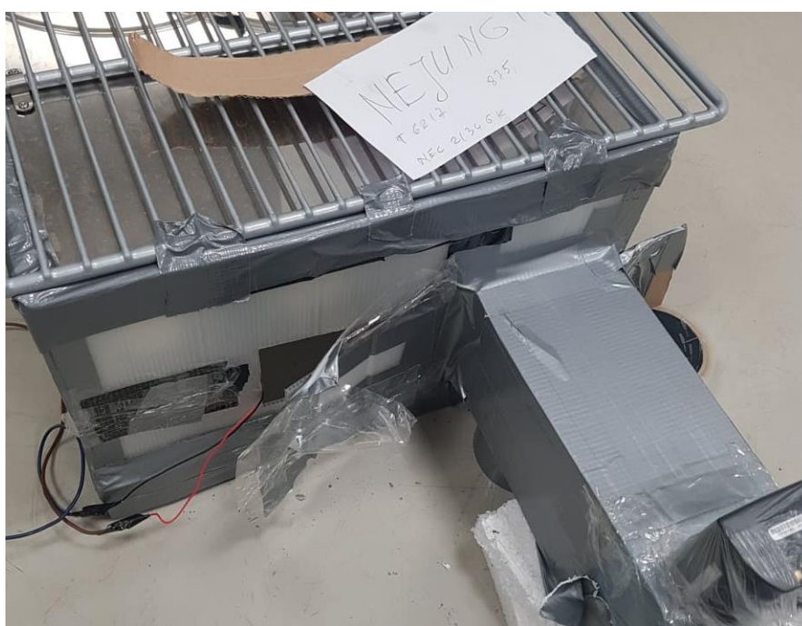
47 pav. Azoto dujų kamera su UV apšvietimo lempomis
