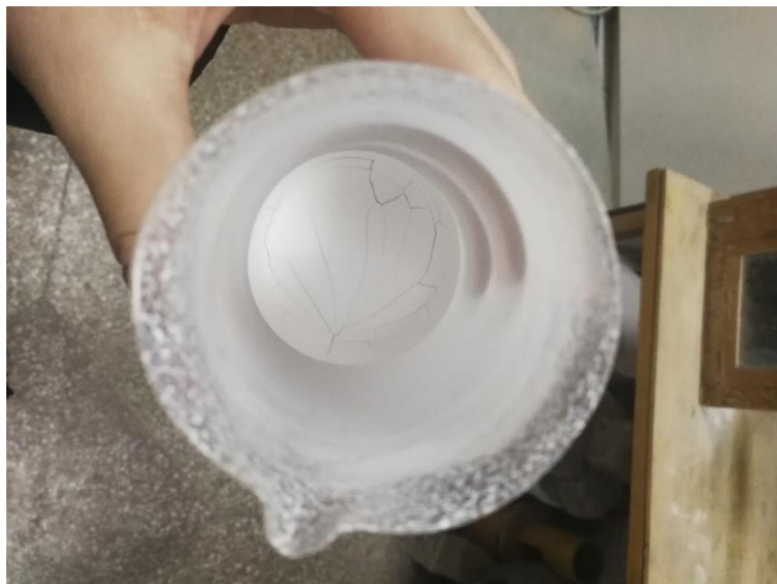
23 pav. Susmulkintas ir išdžiovintas titano dioksidas
