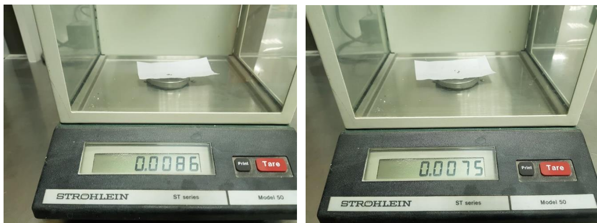
48 pav. Vario svėrimas azoto dujoms gauti
