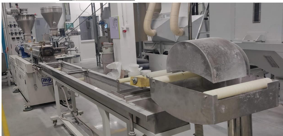
6 pav. Dvigubo sraigto ekstruderis (MP Extruder, Graikija) [54].
