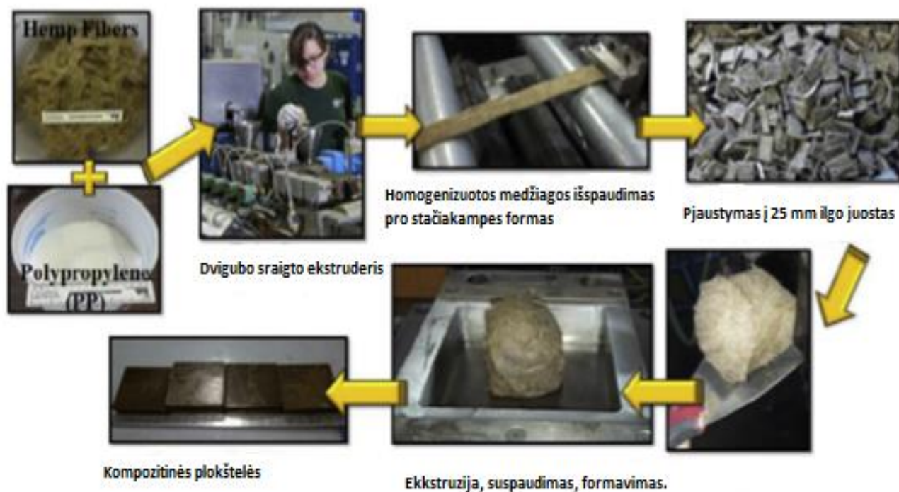
3 pav. PP ir kanapių pluošto kompozito gamybos stadijos [26]
