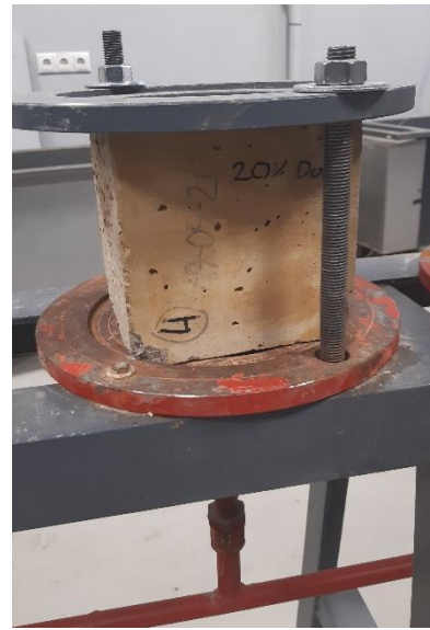
14 pav. Vandens įsiskverbimo į betoną bandymo prietaisai.
