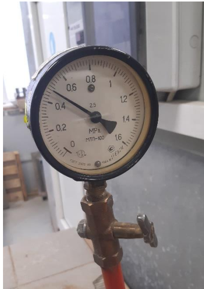
14 pav. Vandens įsiskverbimo į betoną bandymo prietaisai.
