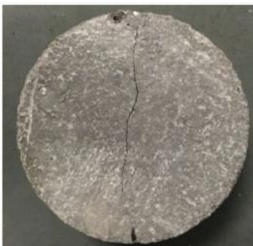
7 pav. Plyšis atvertas cilindro formos bandinyje.
