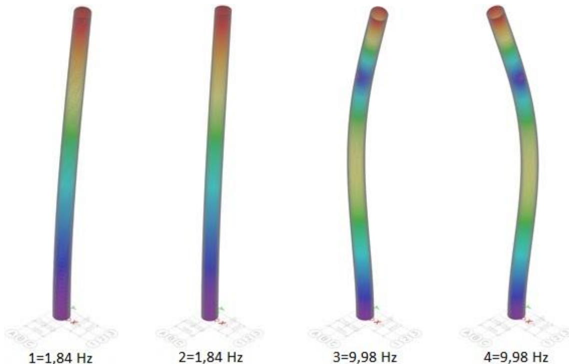
40 pav. I ir II dvimačiuose kevalo modeliuose nustatyti 4 laisvųjų virpesių režimai ir jų dažniai MK1
