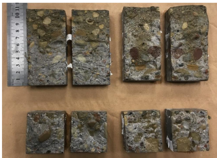
31 pav. Chloridų įsiskverbimo gylis. Kontroliniai (kairėje) ir tiriamieji (dešinėje) bandiniai
