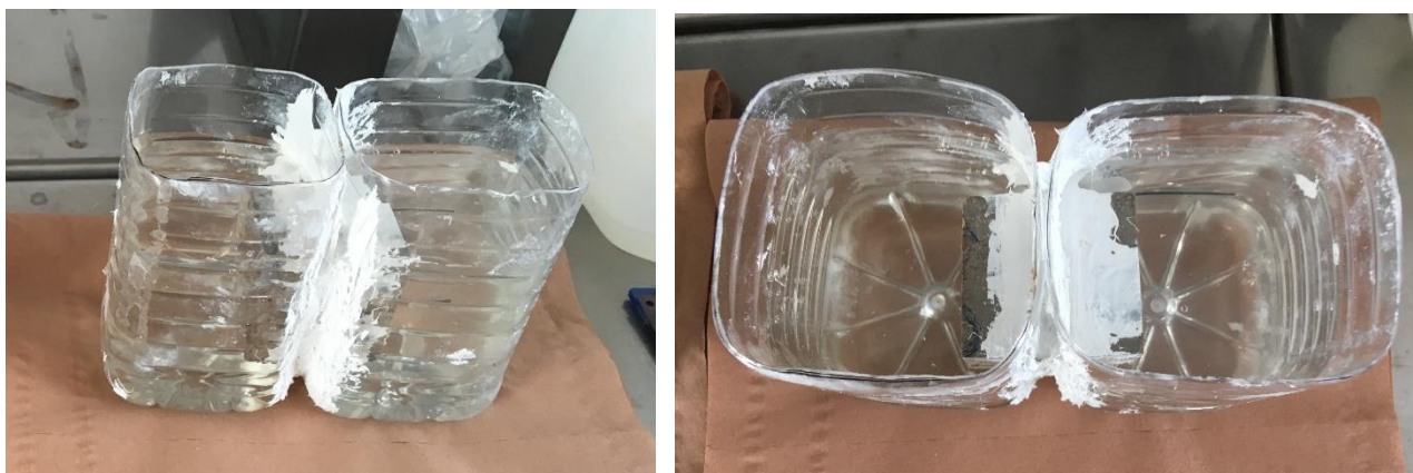
11. pav. Bandinių tvirtinimas išlaikant 1 cm tarpą tarp indų
