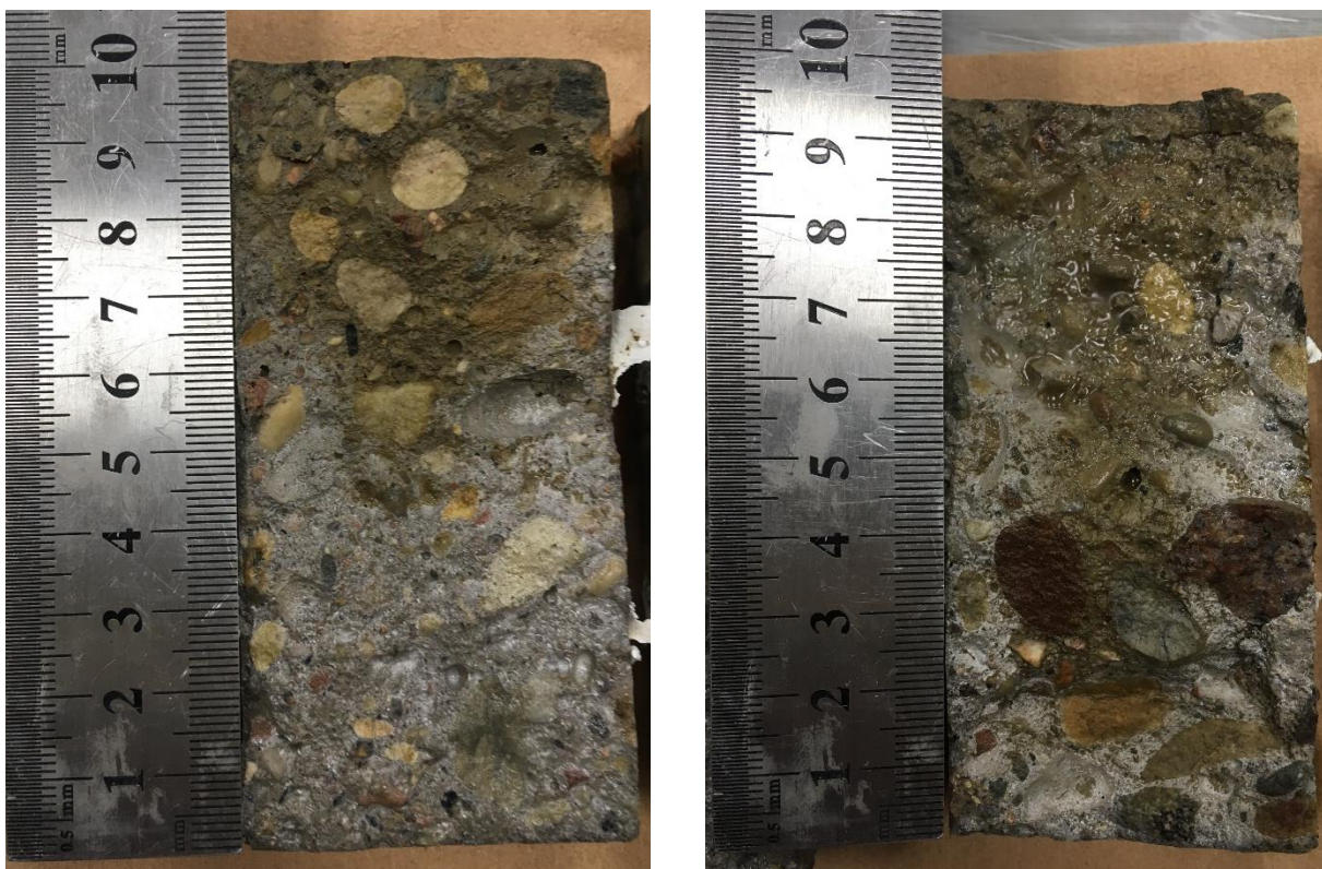
32. pav. Chloridų įsiskverbimo gylis. Kontrolinis (kairėje) ir tiriamasis (dešinėje) bandiniai
