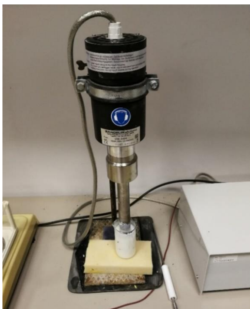
pav. 16 Titano dioksido smulkinimas pasitelkiant ultragarsą
