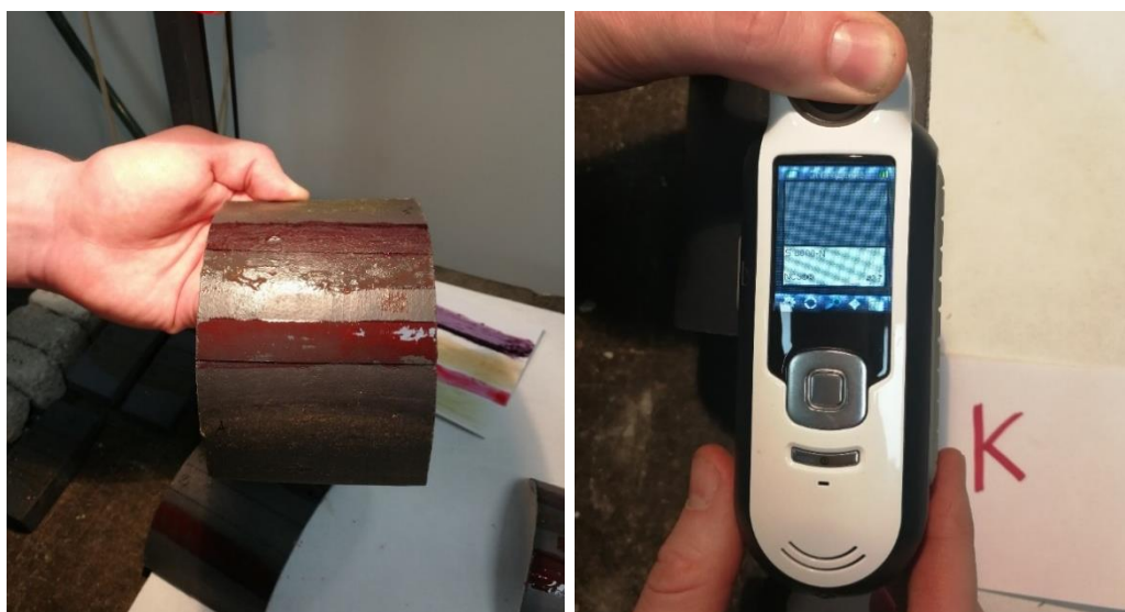
pav. 21 Nudažyti bandiniai ir plataus diapazono prietaisas spalvos kodui nustatyti
