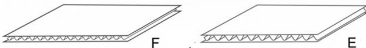
3 pav. F ir E bangos trisluoksnis gofruotasis kartonas [12]
