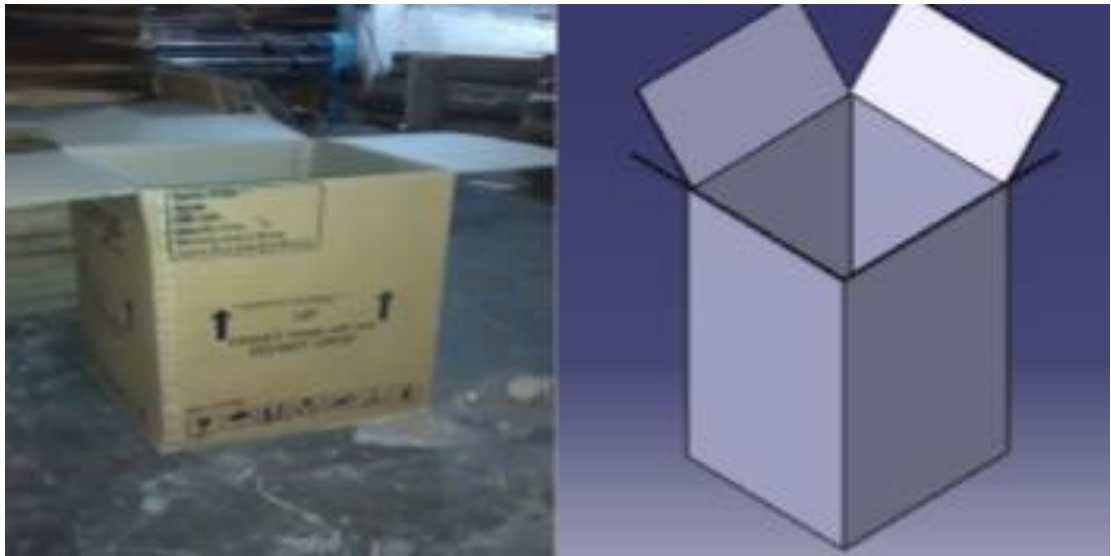
10 pav. Esama gofruoto kartono dėžė ir jos modelis [26]
