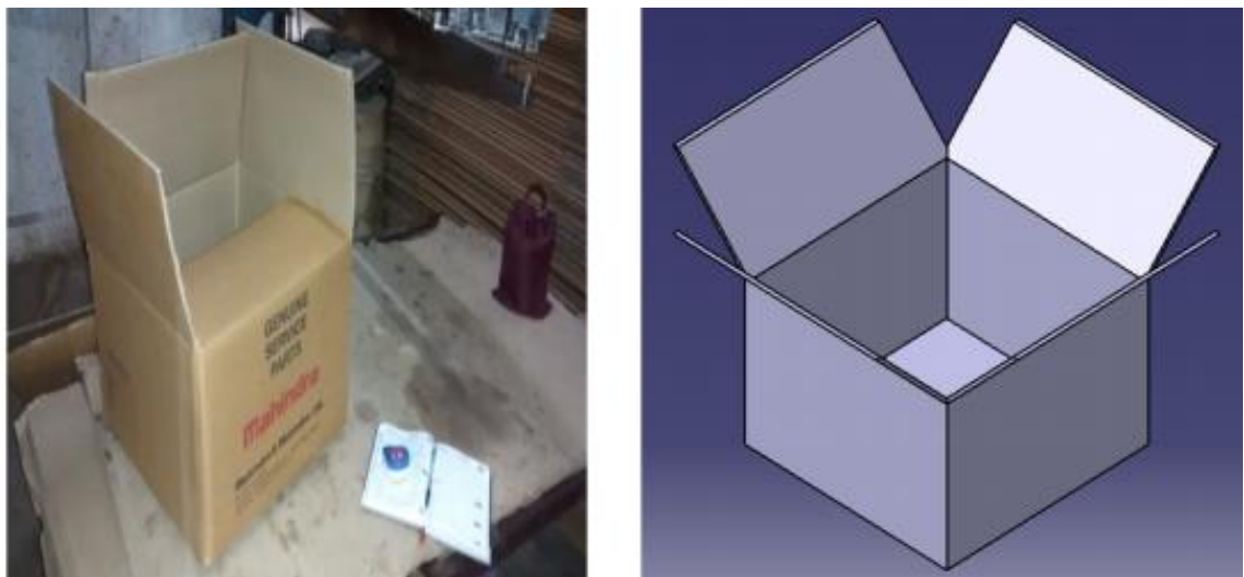
11 pav. Reali gofruoto kartono dėžė ir sukurtas dėžės modelis [26]
