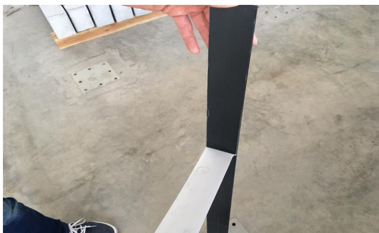
Pav. 10. Naudota anglies pluošto lamelė ir jos paruošimas
