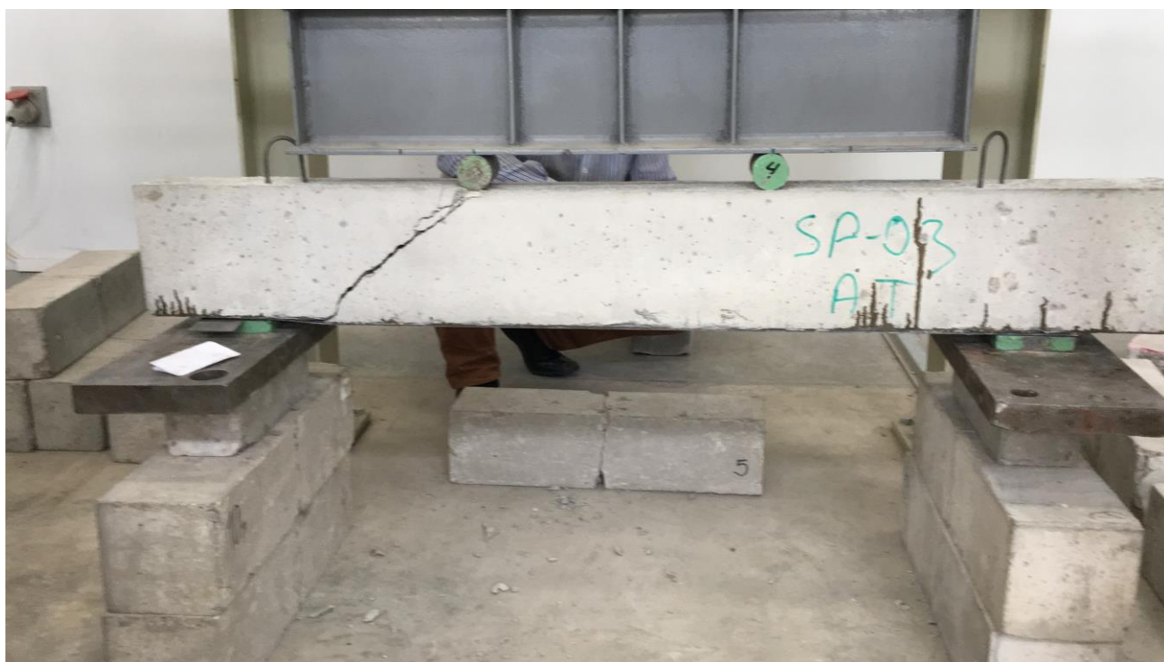
Pav.12. Sustiprintos, plienine juosta, sijos suirimas įstrižajame pjūvyje, , kai priklijuotas elementas užspaudžiamas atramose
