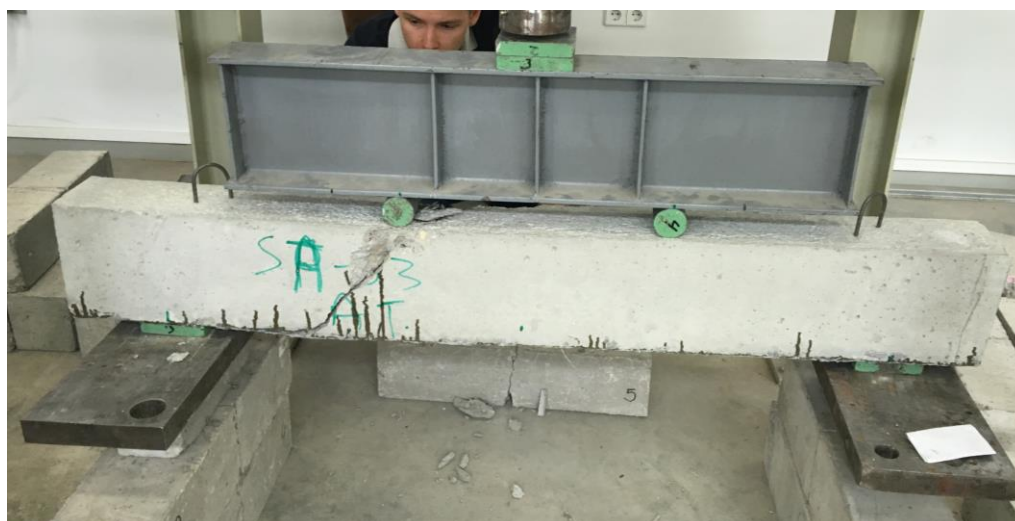
Pav.9. Sustiprintos, anglies pluošto lamele, sijos suirimas įstrižajame pjūvyje, , kai priklijuotas elementas užspaudžiamas atramose
