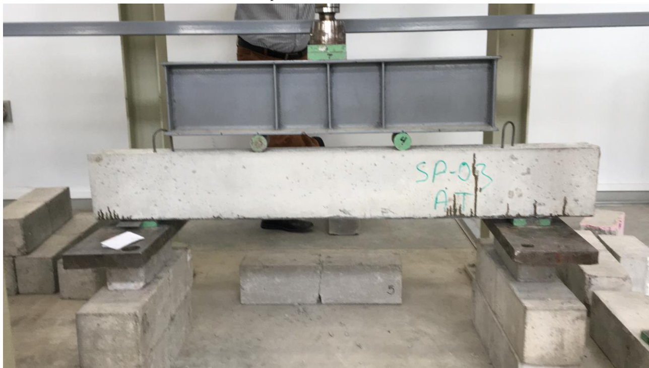
Pav. 11. Sustiprintos, plienine juosta, sijos apkrovimas, kai priklijuotas elementas užspaudžiamas atramose
