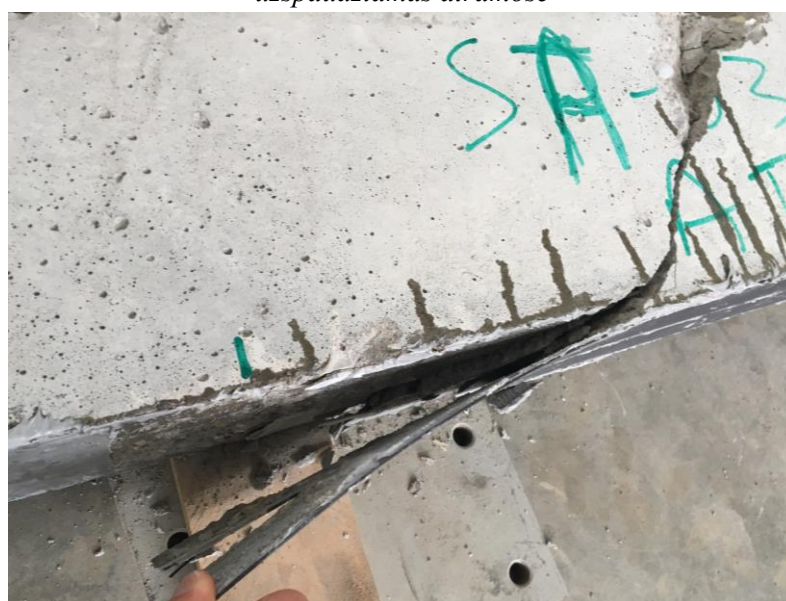
Pav.9. Sustiprintos, anglies pluošto lamele, sijos suirimas įstrižajame pjūvyje, , kai priklijuotas elementas užspaudžiamas atramose
