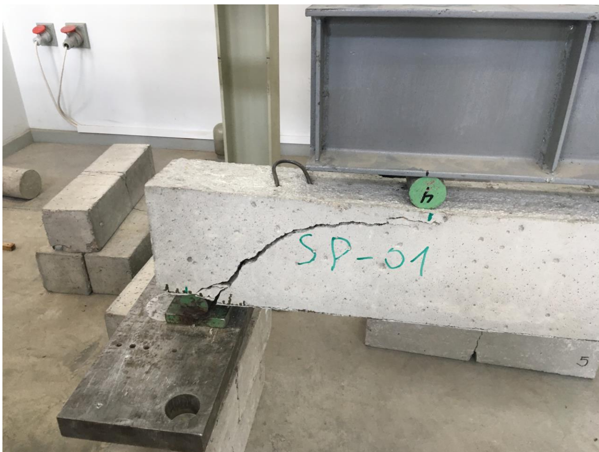
Pav.5. Sustiprintos, plienine juosta, sijos suirimas įstrižajame pjūvyje
