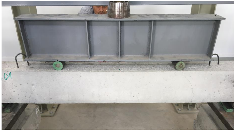
Pav. 1. Nestiprintos sijos apkrovimas
