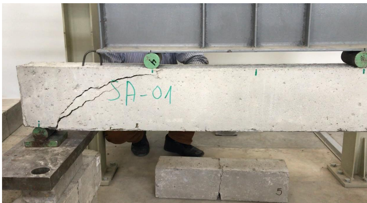
Pav.7. Sustiprintos, anglies pluošto lamele, sijos suirimas įstrižajame pjūvyje
