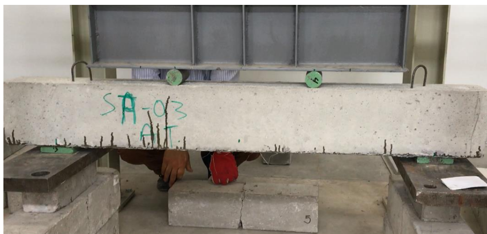
Pav. 8. Sustiprintos, anglies pluošto lamele, sijos apkrovimas, kai priklijuotas elementas užspaudžiamas atramose
