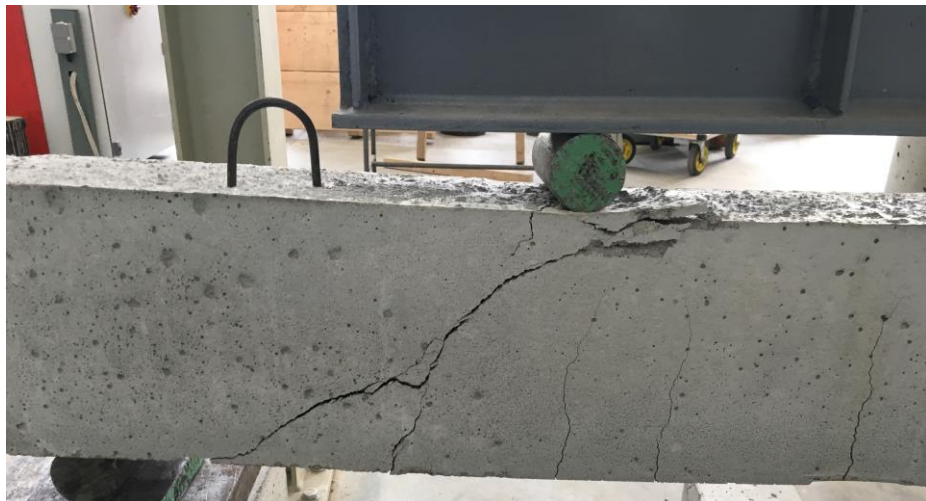
Pav.3. Nestiprintos sijos suirimas įstrižajame pjūvyje
