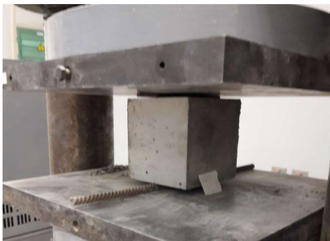
20 pav. Bandinių skėlimas gniuždymo presu
