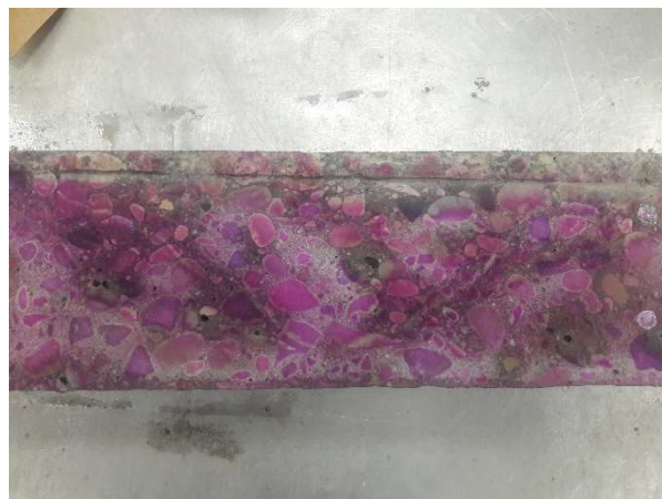
40 pav. Bandinio paviršius užpurškus fenolftaleino
