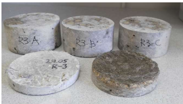
24 pav. Cilindrai supjaustyti į reikiamo dydžio bandinius
