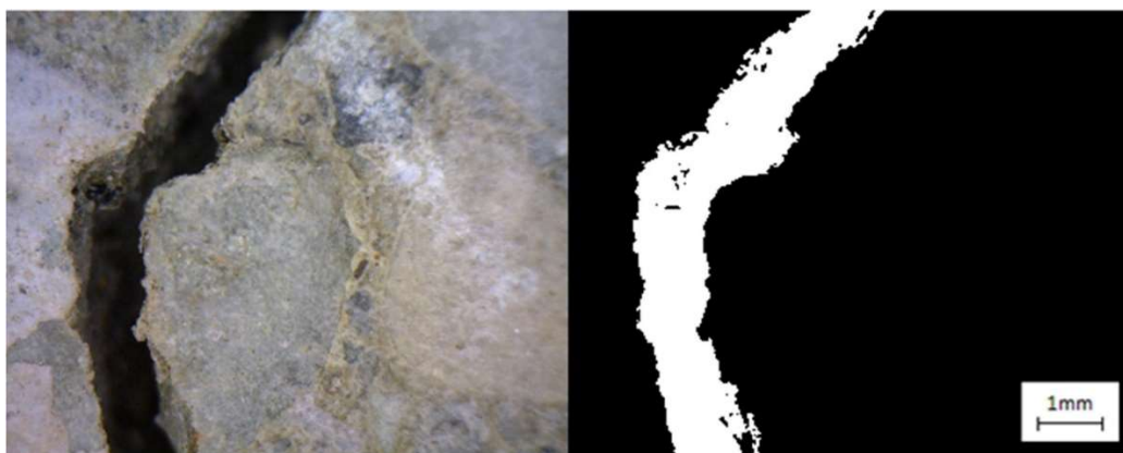
14 pav. Šviesos atspindys įtrūkimo vidiniuose paviršiuose [23]
