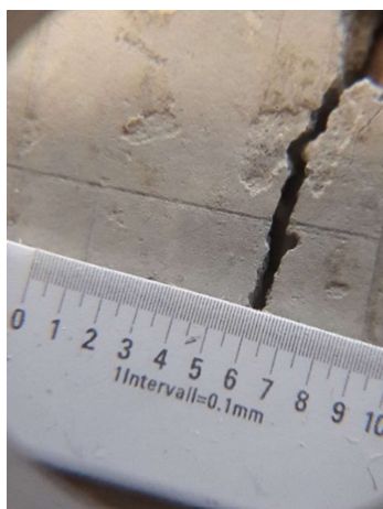
22 pav. 0,3mm pločio plyšio suformavimas
