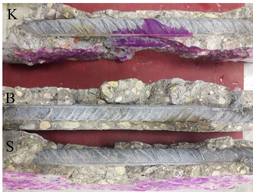
43 pav. Armatūros korozijos židiniai bandiniuose
