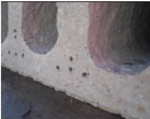
16 pav. Kiaurymėta plokštė pagaminta iš betono su polypropileno fibromis.
