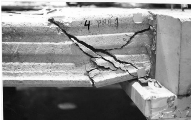
2 pav. Gelžbetoninės kiaurymėtos perdangos plokštės suirimas ties atrama dėl šlyties įtempių. (M.Pajari, 2006)
