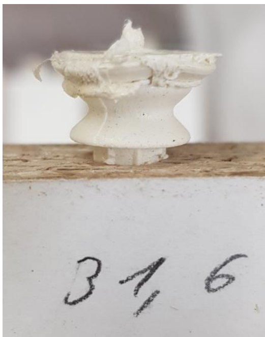
19 pav. Deformuota kaiščio galvutė po suvirinimo ultragarsu, sunkintoje medienos drožlių plokštėje
