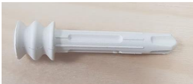
10 pav. Virinimui ultragarsu naudojamas kaištis
