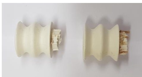
30 pav. Nutrūkusios kaiščių galvutės po traukimo testo „PB2 (650)“ plokštėje
