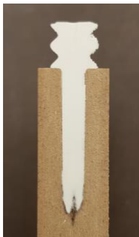
24 pav. Medienos dulkių plokštėje suvirinto termoplastiko kaiščio pjūvis
