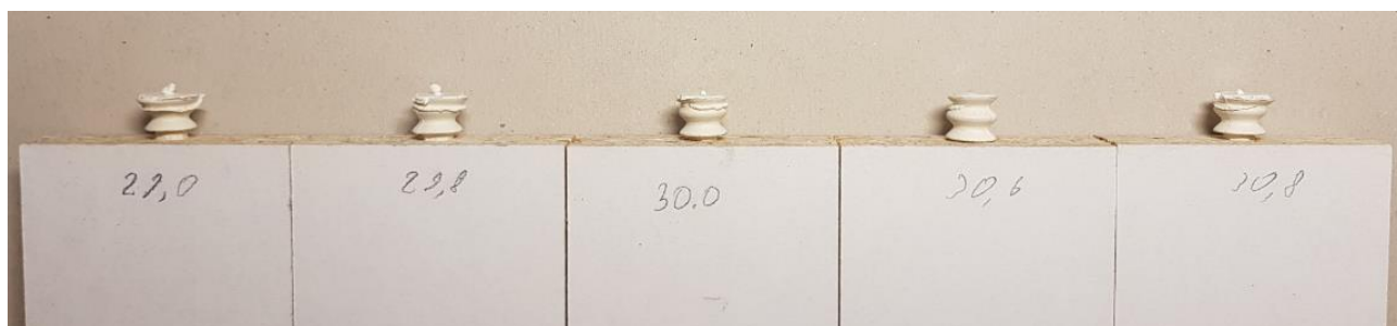
35 pav. Sulydytos ir deformuotos kaiščių galvutės
