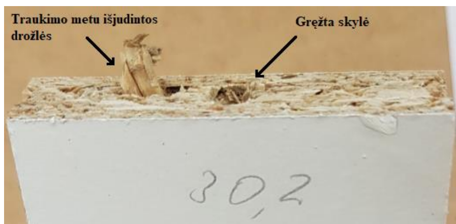
28 pav. Vizualiai matomos išjudintos drožlės ruošinio gale, po kaiščių ištraukimo
