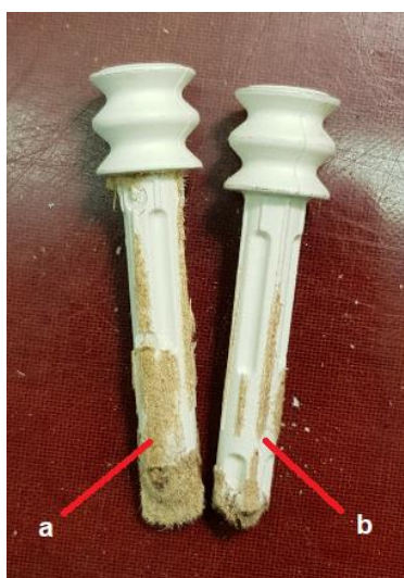
25 pav. a – kaištis ištrauktas iš „MDF Standartas (750)“ plokštės; b – kaištis ištrauktas iš „MDF PLUS (790)“ plokštės
