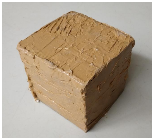
28 pav. Bandinys, padengtas teptine hidroizoliacija
