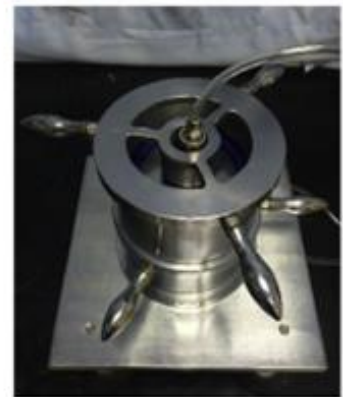
19 pav. Dujų laidumo bandymo principas. Bandymo kamera
