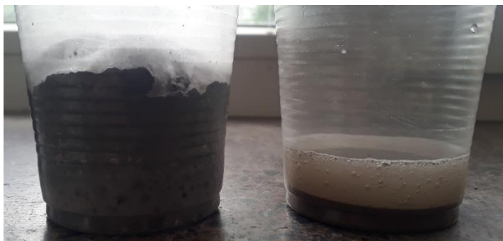
4.15 pav. Aliuminio pudros ir maltos stiklo taros reakcijos į Na(OH) tirpalą
