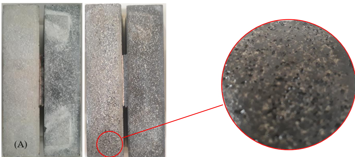
4.16 pav. (A) C735 (cementas), bandinys prieš ir po šaldymo.
