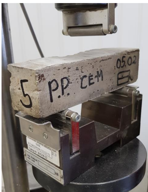
25 pav. Cementinio betono bandinys suformuotas sluoksniais
