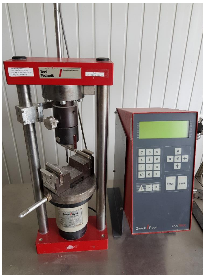
16 pav. Hidraulinis presas „Toni Technik 2020“ lenkimo bandymams atlikti
