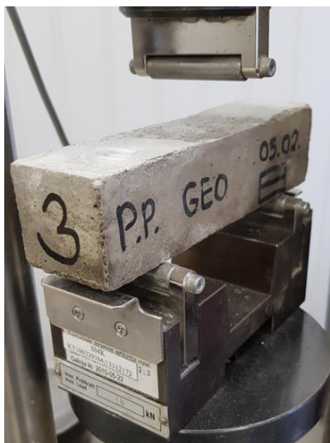
24 pav. Becemenčio betono bandinys suformuotas sluoksniais
