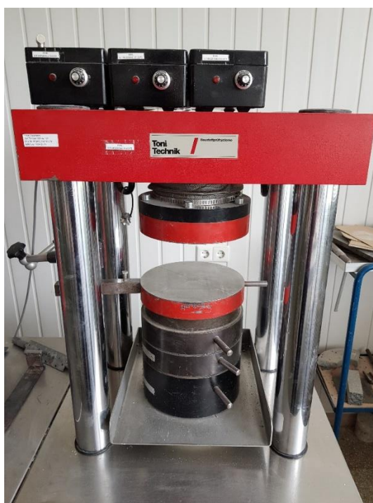
15 pav. Hidraulinis presas „Toni Technik 2020“ gniuždomajam stipriui nustatyti
