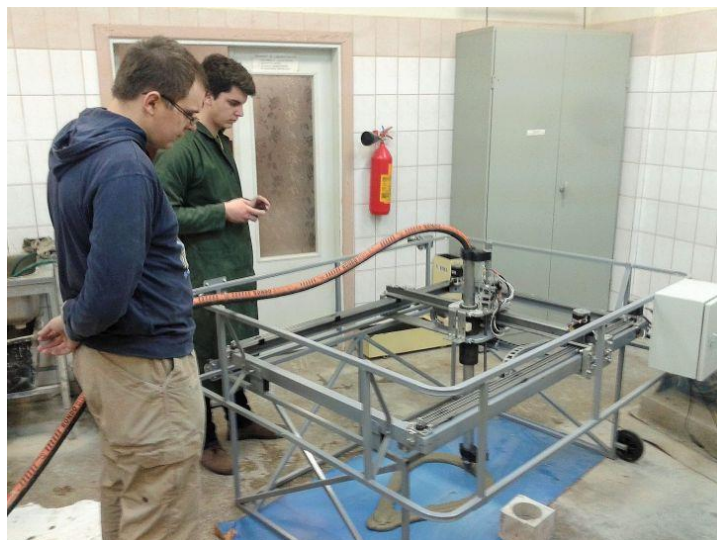
6 pav. 3D spausdintuvas spausdina betono karkasą laboratorijoje [8].
