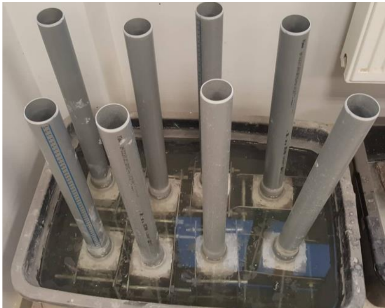
18 pav. Bandinių užmerkimas į vonią atsinaujinimo reakcijai
