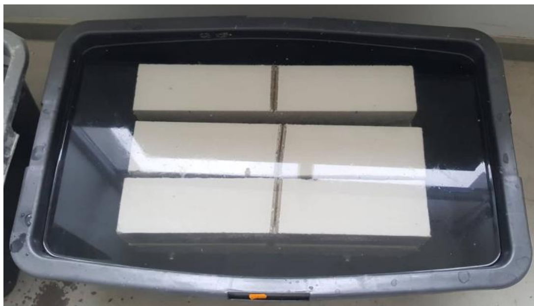
28 pav. Kontrolinių ir su MgO priedu prizminių bandinių užmerkimas
