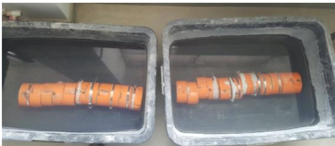
25 pav. Kontrolinių ir su magnio oksido priedu diskinių bandinių užmerkimas
