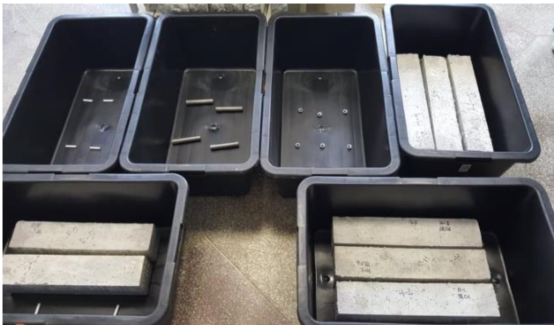
27 pav. Vandens absorbcijos bandymas
