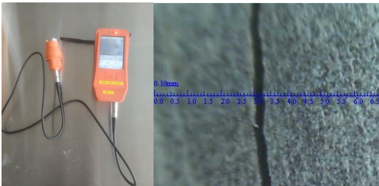
22 pav. Skaitmeninė nuotrauka gauta plyšio matavimo prietaisu
