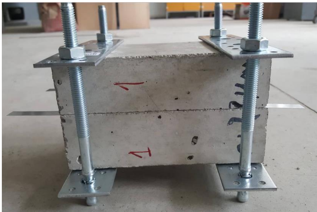
16 pav. Plyšio sudarymas nestandartiniu metodu
