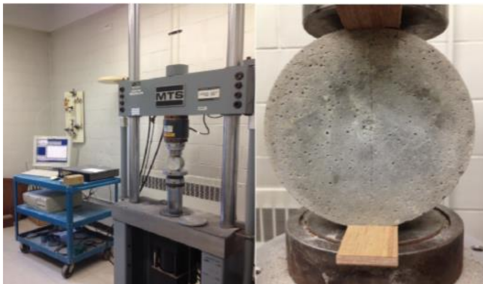
9 pav. Plyšio formavimas skėlimo metodu [5]
