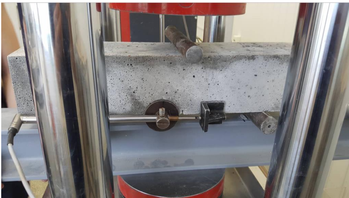
21 pav. Plyšių atvėrimas hidrauliniu presu lenkimo metodu
