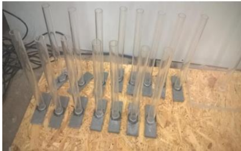
11 pav. Atsinaujinimo patikrinimas vandens pralaidumo metodu [4]
