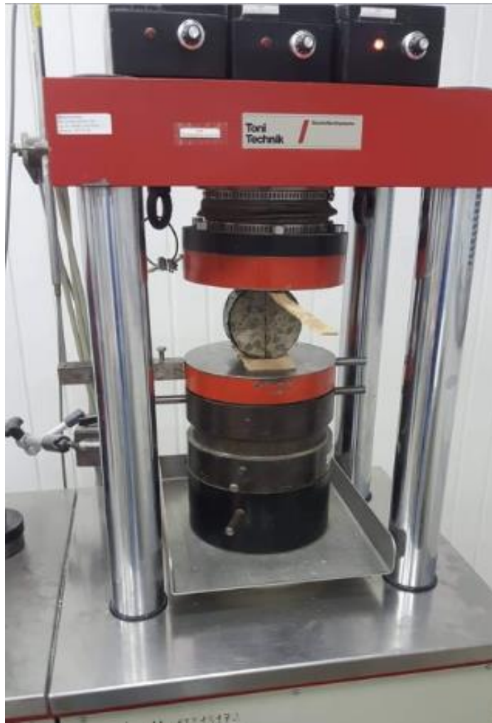
20 pav. Plyšių atvėrimas hidrauliniu presu skėlimo metodu
