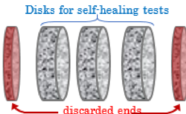
19 pav. Cilindrinų bandinių supjovimo metodika
