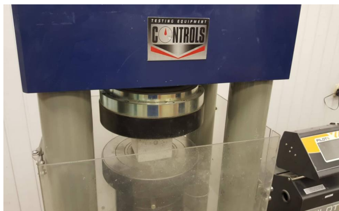
29 pav. Betono gniuždomojo stiprio nustatymas po 28 parų
