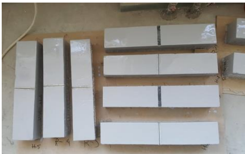
26 pav. Prizminių bandinių paruošimas
