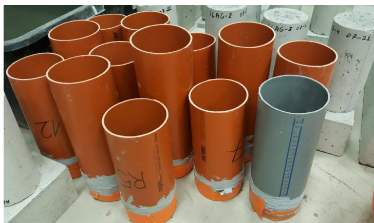
23 pav. Diskinių bandinių paruošimas vandens pralaidumo bandymui
