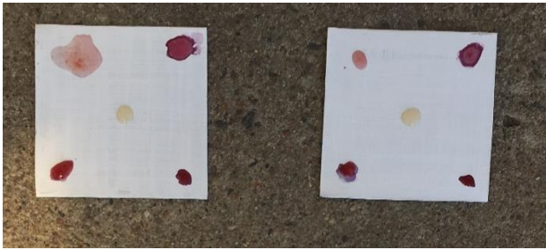
40 pav. Fasadinių dažų bandiniai, užtepti organinės kilmės dėmėmis (kairėje) ir po 10 d. UV poveikio (dešinėje)
