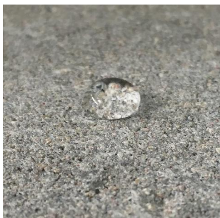
25 pav. Vandens lašas ant bandinio TiO 2 paviršiaus
