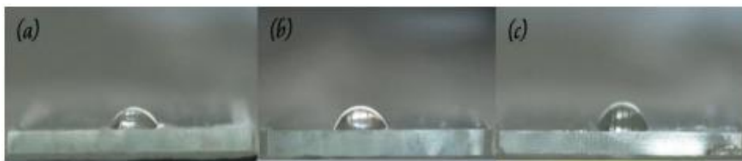
8 pav. Lašo kontakto kampo pakeitimo pavyzdys: užtepus a) 1 sluoksnį b) 2 sluoksnius c) 3 sluoksnius
