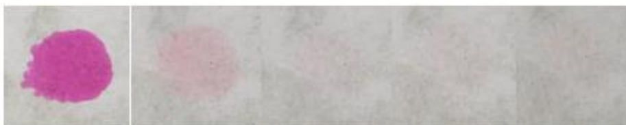
12 pav. 9% mikro- \text{TiO}_2 dėmės skaidymas, kas 24 val.
