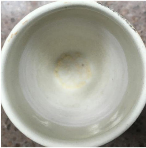
49 pav. Milteliai, susidarę bandinį kaitinant mikrobangų krosnelėje
