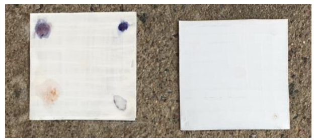
40 pav. Fasadinių dažų bandiniai, užtepti organinės kilmės dėmėmis (kairėje) ir po 10 d. UV poveikio (dešinėje)
