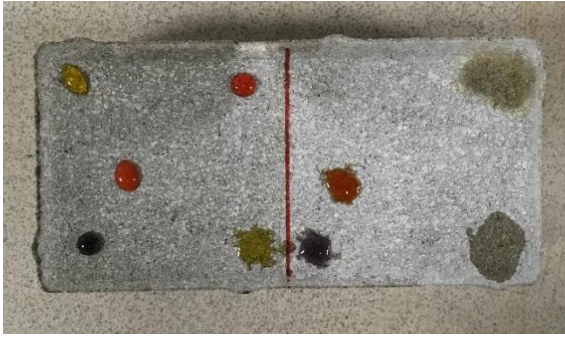
39 pav. Silano-siloksano bandiniai, užtepti cheminiais indikatoriais (kairėje) ir po 45 d. UV poveikio (dešinėje)
