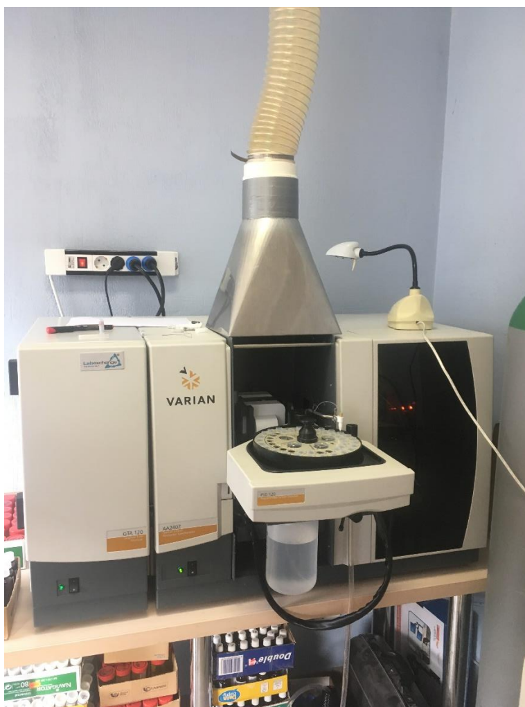
16 pav. „Zeeman“ atominės absorbcijos spektrometras, su grafito krosnimi
