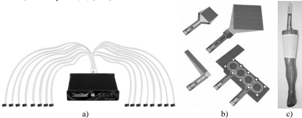
1.11 pav. Kompresijos matavimai: a) Tactilus® jutiklių sistema [102]; b) I-Scan prietaiso galimos jutiklių formos [103]; c) I-Scan prietaisas matavimo metu [67]
