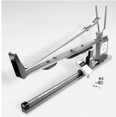
1.8 pav. Kompresijos matavimo prietaisas Satra STM 579 [96]
