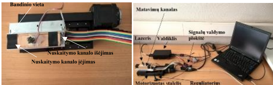
25 pav. Dozių fotoskaitytuvo prototipas (a) ir fotoskaitytuvo valdymo/signalų registravimo sistema (b)
