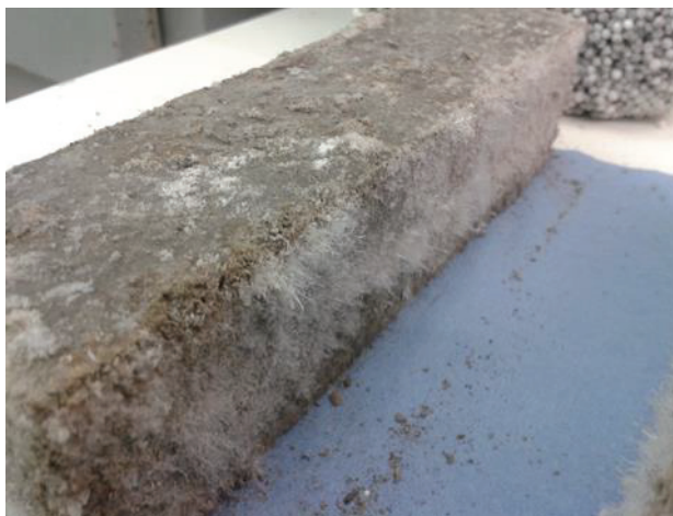
49 pav. Natrio karbonato išnašos ant geopolimerinio betono bandinių
