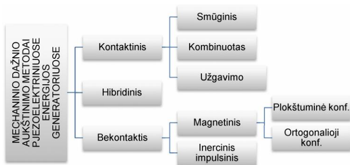
1.6 pav. Pjezoelektrinių vibracinių energijos generatorių, veikiančių mechaninio dažnio aukštinimo režimu, kvalifikavimas
