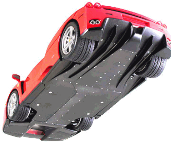
8 pav. Lygus dugnas ir gale įtaisytas difuzorius [13]
