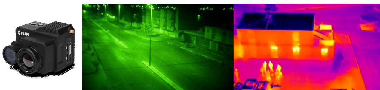
2.5 pav. Flir Duo Pro R kamera, naktinio ir termo matymo režimai
