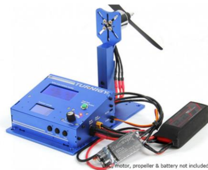
59 pav. Horizontalus matavimo stendas „Turnigy Thrust Stand“ [25]
