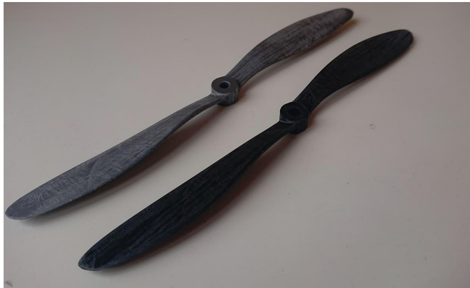
41 pav. Pagaminti propeleriai. Juodos spalvos gamintas iš PETG plastiko, sidabrinės spalvos gamintas iš PLA plastiko
