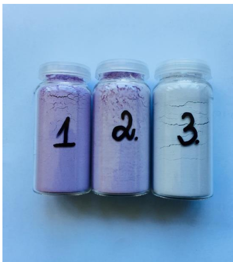
3.11 pav. Mikrokapsuliacijos būdu gauti milteliai naudojant skirtingas dangas: (1) maltodekstriną, (2) modifikuotą krakmolą HI-CAP, (3) maltodekstrino/išrūgų baltymų mišinį (santykiu 2:1)
