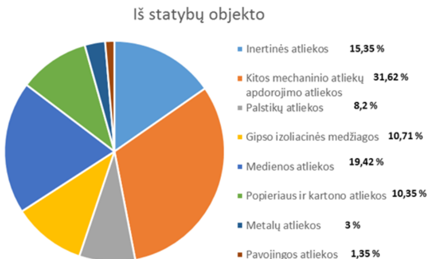
14 pav. Mišrių statybinių ir griovimo atliekų procentinė sudėtis atlikus rūšiavimo eksperimentą (2)
