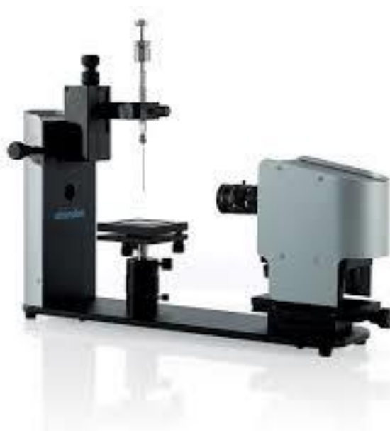
2.7 pav. Biolin Scientific Theta Lite 101 analizatorius, naudotas tiriant vilgumo kampą.
