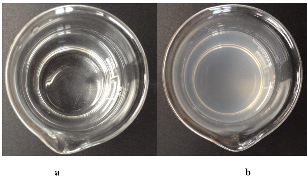
3.7 pav. KOEK/AOEK-NaTPP polikompleksų susidarymo vandenyje vizualinis įvertinimas. Bandinių fotonuotraukos: a – vandenyje tirpus KOEK/AOEK-NaTPP polikomplekso tirpalas; b – stabili opalescuojanti KOEK/AOEK-NaTPP polikomplekso dalelių vandeninė dispersinė sistema
