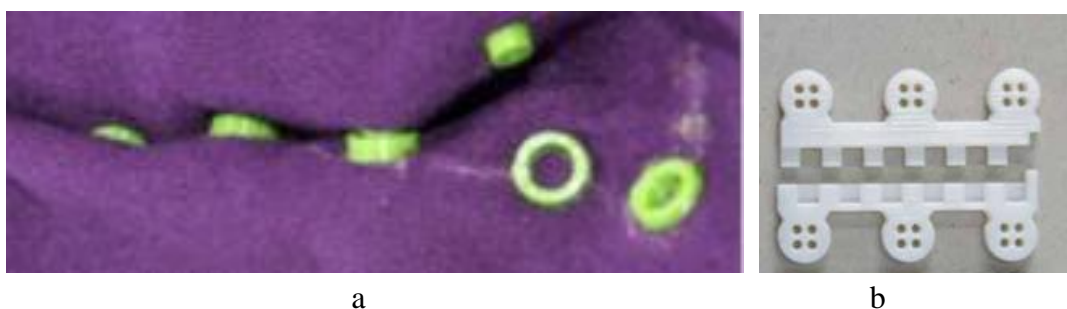
1.15 pav. a) Tiesioginis spaudžių tvirtinimo metodas prie medžiagos [31]. b) 3D spausdinimo metodu pagaminta jungtis [32]
