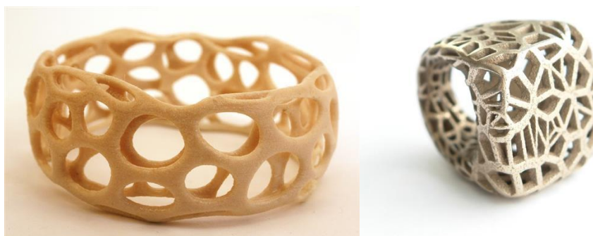
1.6 pav. Objektai atspausdinti selektivaus lydymo spausdinimo principu [10]
