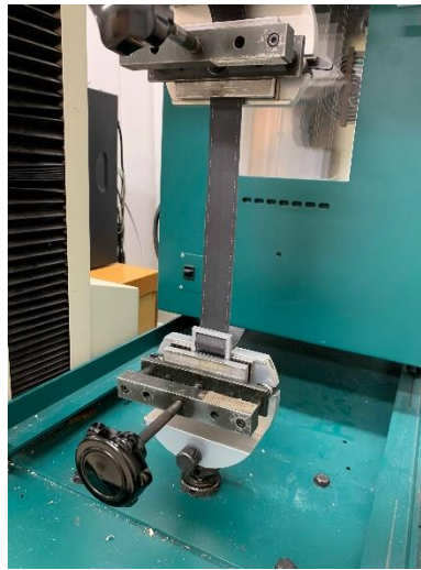
0.24 pav. Praslydimo bandymas: reguliatoriaus ir odinio diržo tvirtinimas spraustuvoose
