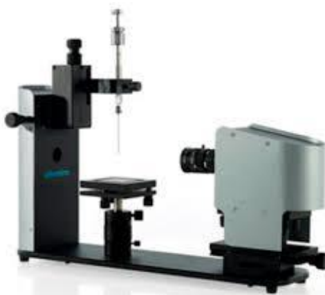
2.9 pav. Biolin Scientific ThetaLite 101 analizatoriaus nuotrauka
