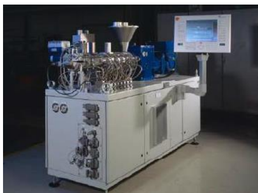
2.1 pav. Dviejų sraigtų reakcinio ekstruderio KraussMaffei nuotrauka
