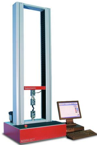
2.11 pav. Aparatūros TESTOMETRIC DBBMTCL-5000kg-1.5-000 naudoto mechaninėms savybėms nustatyti nuotrauka
