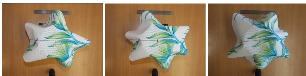
2 pav. Bandiniai su 03 audinio struktūriniais ir mechaniniais parametrais
