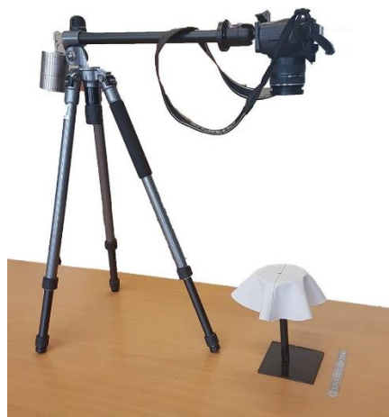
2. 10 pav. Drapiravimosi stendas su fotoaparatu ir stoveliu
