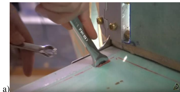
20 pav. a) Kilio ir stabilizatoriaus galinių dalių jungimas per T formos detalę. b) Kilio ir stabilizatoriaus priekinių dalių jungimas per L formos detales [42]
