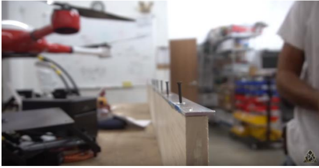
23 pav. Lonžerono stiprinimas aliumine juostele [43]. 24 pav. Sparnų tvirtinimo mazgų tvirtinimas [43].
