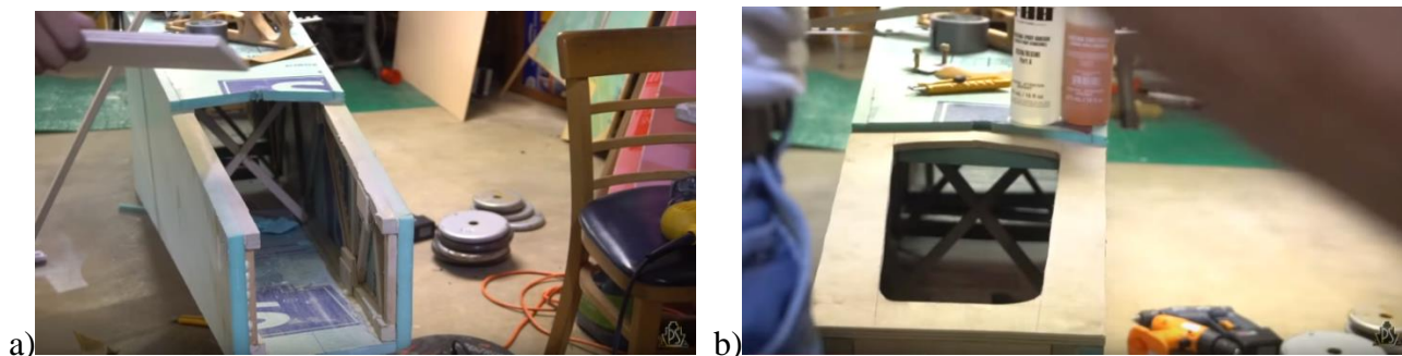
21 pav. a) Ertmės išpjovimas galinėje liemens dalyje. b) Jungiamosios dalies įklijavimas galinėje liemens dalyje [42]
