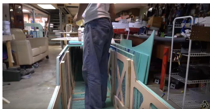
4 pav. Ant apatinės dalies paklijuoti ferminės konstrukcijos elementai jungimui tarp šoninių dalių bei papildomos juostelės virš lonžeronų atramų tvirtinimo vietų [40]
