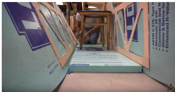
3 pav. 25 mm. storio šoninių fiuzeliažo dalių jungimas su apatine 50 mm. storio fiuzeliažo dalimi po pilotu ir sparnais [40]
