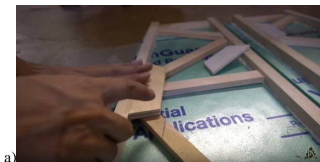
2 pav. a) Ferminės konstrukcijos jungimas jungiamąja plokštele. b) Sujungti serminės konstrukcijos mazgai [40]
