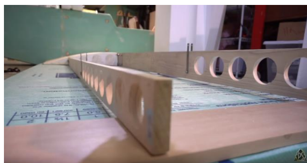
37 pav. Pagrindinio lonžerono sustiprinimas plokštele [44]. 38 pav. Viršutinio ir apatinio sparnų jungimo vietų tvirtinimo detalių ir trosų tvirtinimo detalių priveržimas [44]
