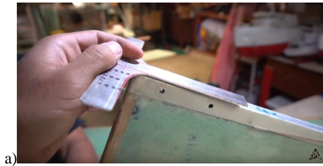
19 pav. a) T formos detalė kilio ir stabilizatoriaus galinių dalių jungimui. b) T formos detalės tvirtinimas prie kilio [42]
