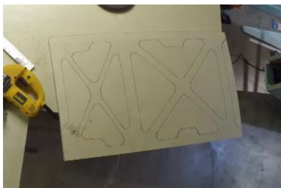
7 pav. Dengiamoji plokštė su išėmomis viršutinių sparnų tvirtinimo vidurinėms atramoms [40]
