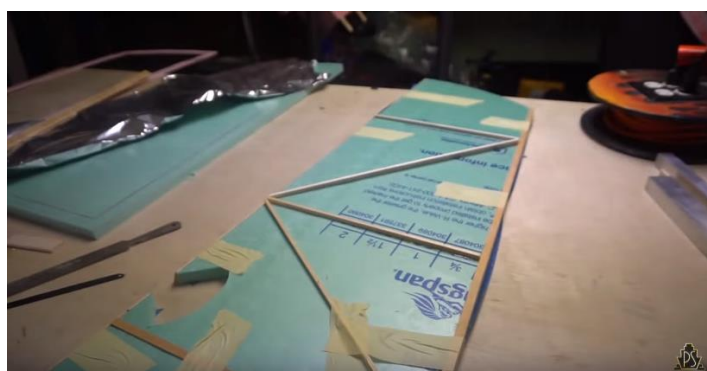
13 pav. Posūkio vairas sustiprintas išilginiais ir skersiniais tašeliais [41]
