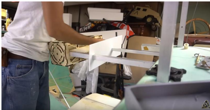
46 pav. Variklių blokų tvirtinimas prie fiuzeliažo [45]
