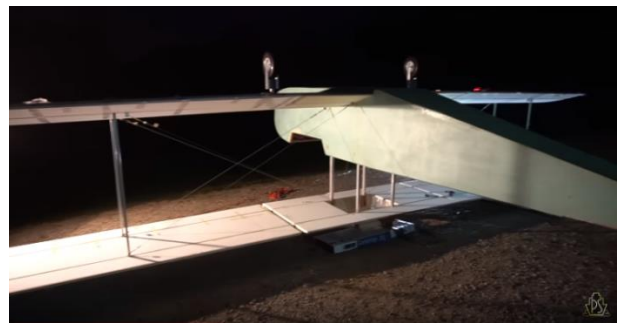
43 pav. Viršutinio ir apatinio šoninių sparnų tarpusavyo jungimas [44]. 44 pav. Troselių įtempimas [44]
