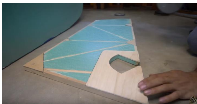
17 pav. Mazgų apjungimas jungiamosiomis plokštelėmis, priekinės briaunos kampas 60^\circ [41]
