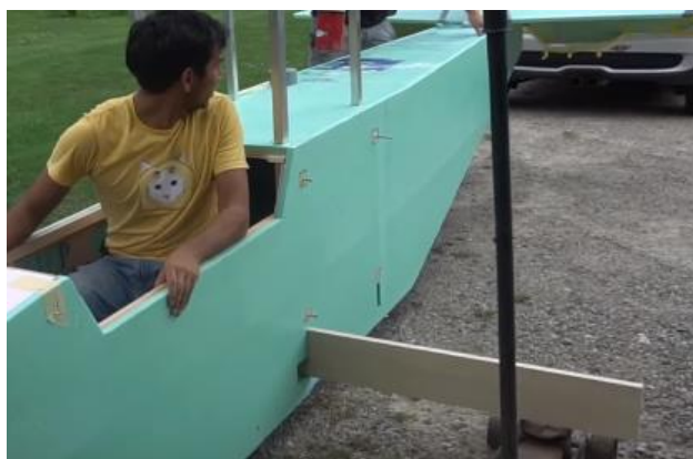
11 pav. Viršutinio sparno atramų tvirtinimas prie fiuzeliažo šonų [41]
