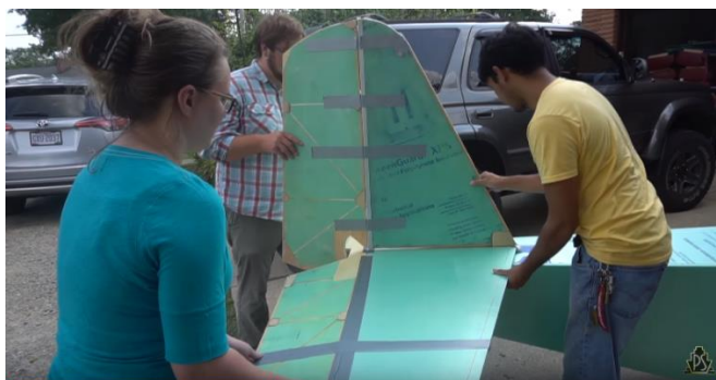
15 pav. Tašelių intarpai galinėse plokštumose ir mazgų surišimas įleistomis jungiamosiomis faneros plokštelėmis [41]
