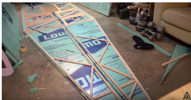
1 pav. Fiuzeliažo šoninės dalys, ties piloto vieta pastorintos fanera, ir ferminė uodegos konstrukcija [40]
