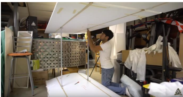
43 pav. Viršutinio ir apatinio šoninių sparnų tarpusavyo jungimas [44]. 44 pav. Troselių įtempimas [44]
