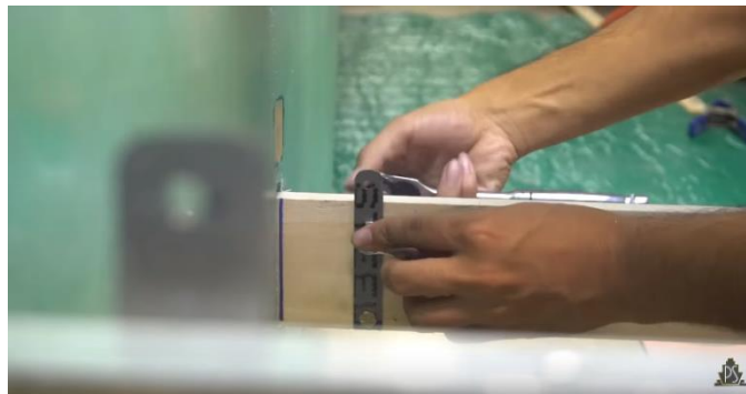
25 pav. Trosų tvirtinimo vietų įrengimas [43]
