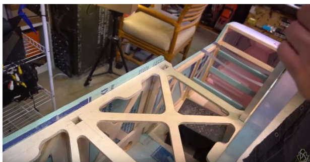
8 pav. Įmontuota dengiamoji plokštė už piloto nugaros su išėmomis viršutinių sparnų tvirtinimo vidurinėms atramoms [40]
