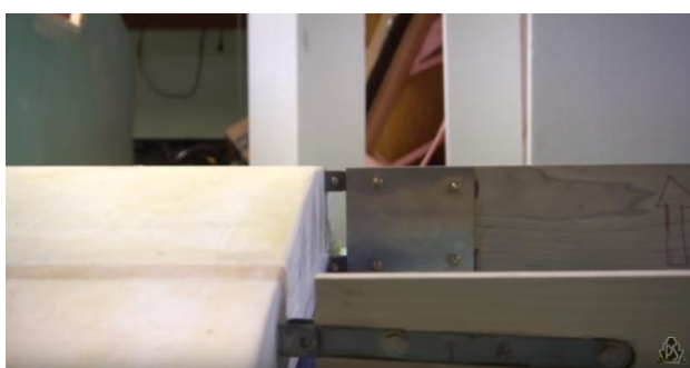
37 pav. Pagrindinio lonžerono sustiprinimas plokštele [44]. 38 pav. Viršutinio ir apatinio sparnų jungimo vietų tvirtinimo detalių ir trosų tvirtinimo detalių priveržimas [44]
