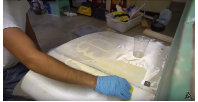
28 pav. Galinės sparno dalies stiprinimas tašeliu [43]. 29 pav. Sparno dengimas audiniu ir derva [43]
