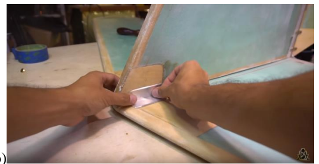
20 pav. a) Kilio ir stabilizatoriaus galinių dalių jungimas per T formos detalę. b) Kilio ir stabilizatoriaus priekinių dalių jungimas per L formos detales [42]
