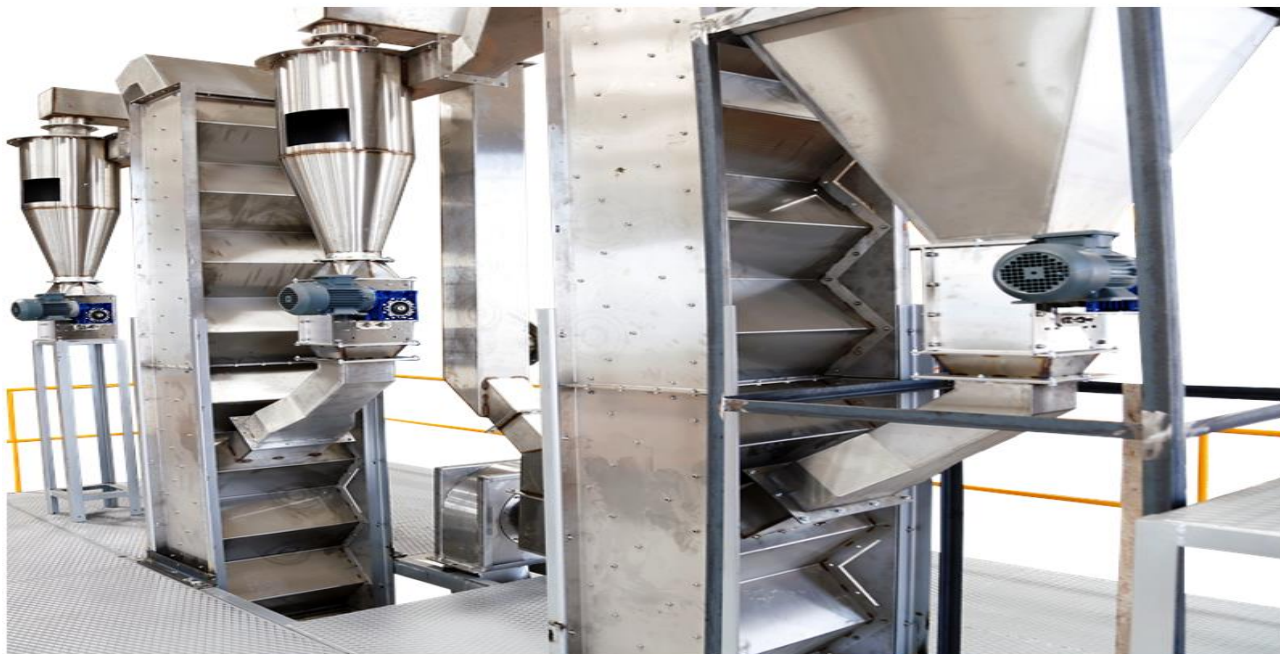
3 pav. Turkijos kompanijos AKYUREK Kardesler Ltd gaminamas „ZigZag“ separatorius
