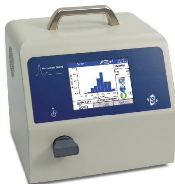
7 pav. Nanodalelių skaitinės koncentracijos matuoklis, TSI 3910 Nanoscan Nanoparticle Sizer [39]
