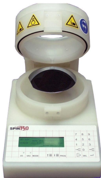
2.2 pav. Besisukančio padėklo metodo aparatas SPIN 150 [36]
