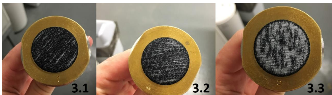
25 pav. Skalbti bandinai iš vilnos/šilko 22 tex verpalų + PU/PA6 po 50000 sūkių. Iš dešinės: 3.1, 3.2 ir 3.3 bandiniai
