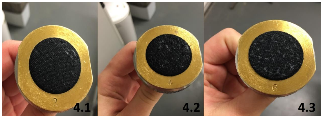
29 pav. Skalbti bandinai iš medvilninių 29tex verpalų + PU/PA6 po 50000 sūkių. Iš dešinės: 4.1,4.2 ir 4.3 bandiniai
