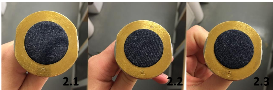
21 pav. Skalbti bandinai iš pusvilnionių 25tex verpalų + PU/PA6 po 50000 sūkių. Iš dešinės: 2.1, 2.2 ir 2.3 bandiniai
