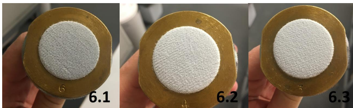
36 pav. Neskaltos mezgtinės medžiagos iš medvilninių verpalų + „Skinlife“ siūlai po 50000 sūkių. Iš dešinės: 6.1, 6.2, 6.3 bandiniai
