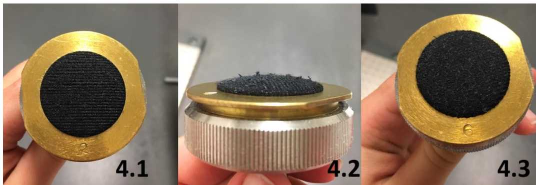
28 pav. Nescalbti bandinai iš medvilninių 29tex verpalų + PU/PA6 po 50000 sūkių. Iš dešinės: 4.1,4.2 ir 4.3 bandiniai
