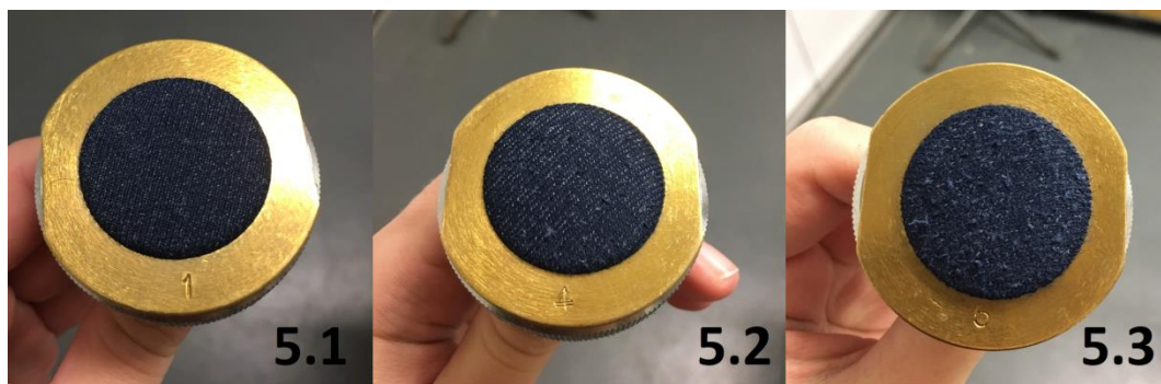
32 pav. Nescalbti bandinai iš medvilninių 25tex verpalų + PU/PA6 po 50000 sūkių. Iš dešinės: 5.1, 5.2 ir 5.3 bandiniai
