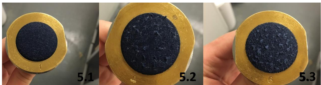
33 pav. Skalbti bandinai iš medvilninių 25tex verpalų + PU/PA6 po 50000 sūkių. Iš dešinės: 5.1, 5.2 ir 5.3 bandiniai
