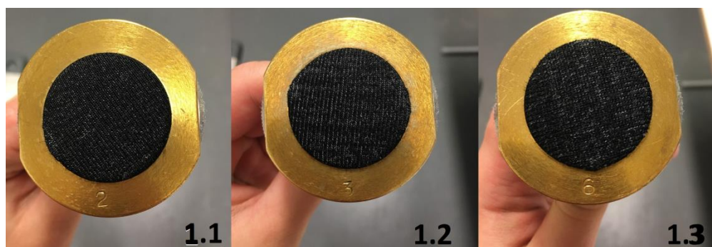
16 pav. Nescalbti bandinai iš pusvilnionių 33tex verpalų +PU/PA6 po 50000 sūkių. Iš dešinės: 1.1, 1.2 ir 1.3 bandiniai
