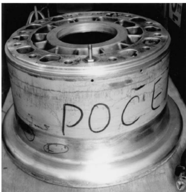
1.3 pav. Orlaivio rato pagaminto iš Aliuminio lydinio 2014-T6 defektai [23-2]
