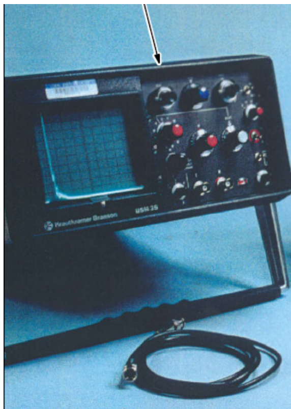
2.4 pav. Ultragarso metodo neardomos kontrolės inspekcijai naudojama įranga [17-51]
