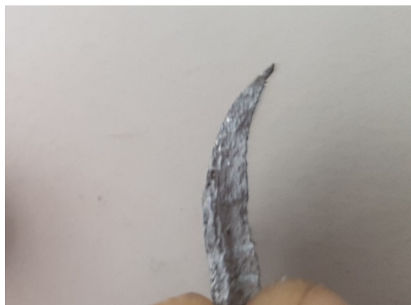
6.5 pav. Silumino dangos gabalėlis profiliu
