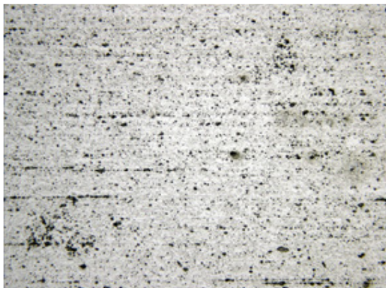
9.1 pav. 2024 serijos aliuminio lydinio mikrošlifo vaizdas padidinus 200 kartų
