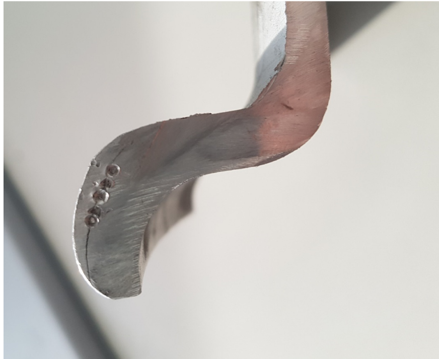
6.1 pav. Dirbtinis silumino dangos skilimo formavimas
