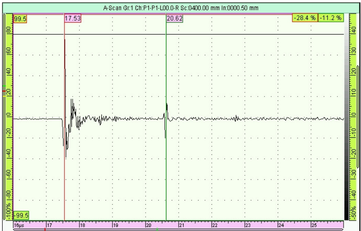
5.2 pav. Bandinio matavimas ultrgarsu, po padengimo siluminu, rezultatai
