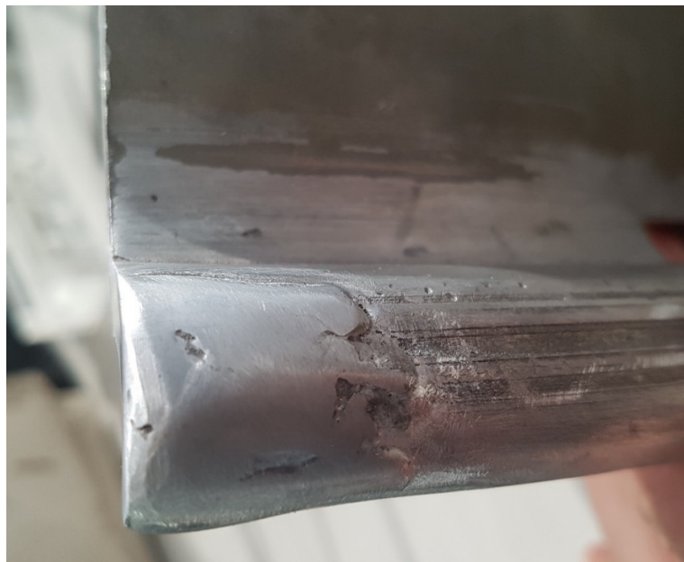
8.1 pav. TIG suvirinimo būdu užnešta 5356 danga
