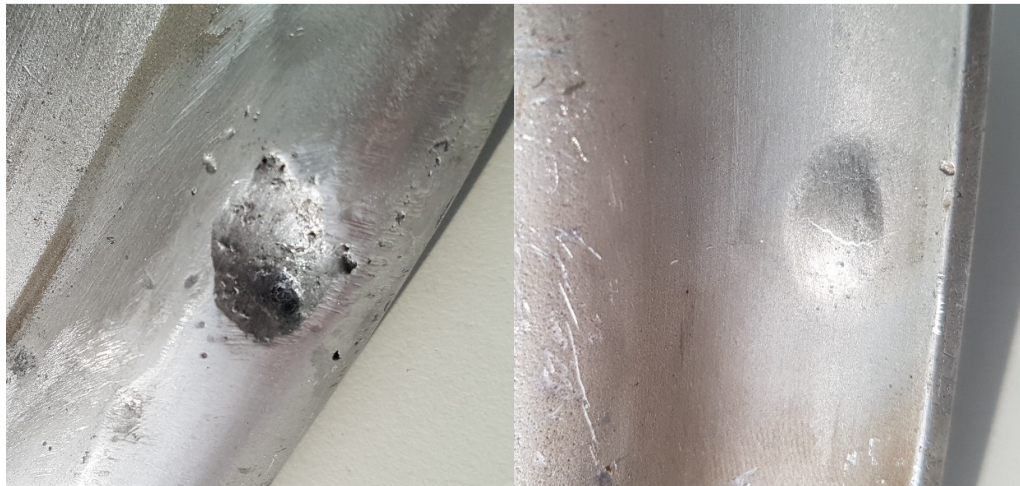
6.8 pav. Dangos perlydymo metu, matoma perkaitimo deformacija
