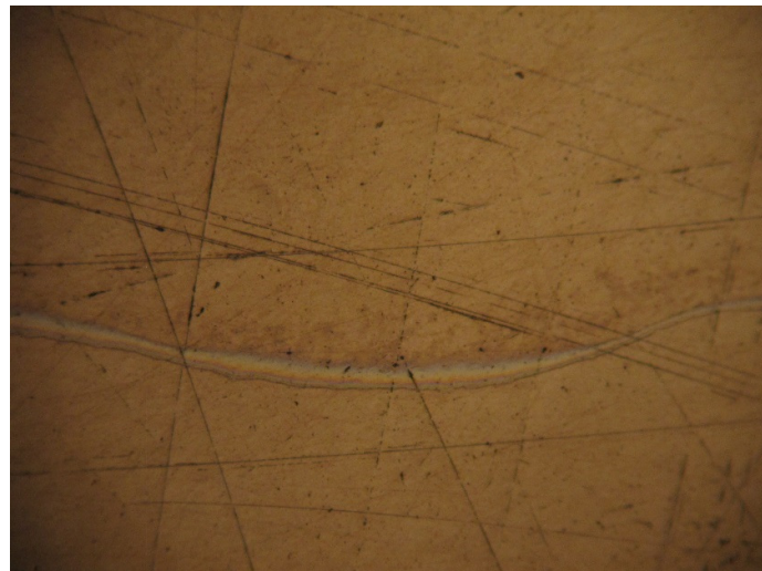
9.11 pav. Bandinys su danga, suformuota inertinėse dujose, padidinus 5 kartus
