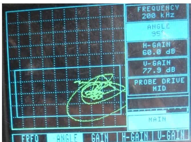
4.17 pav. Matavimas sukūrinėmis srovėmis
