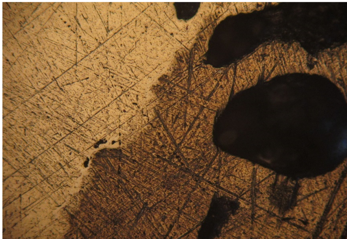
9.7 pav. Bandinys, su silumino danga, perlydyta, inertinėse dujose, padidinus 5 kartus
