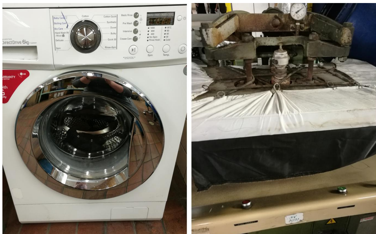
3.18 pav. Įrenginiai, naudoti testui buitinio skalbimo ir džiovinimo procedūros bandant tekstilę (ISO6330:2012) atlikti
