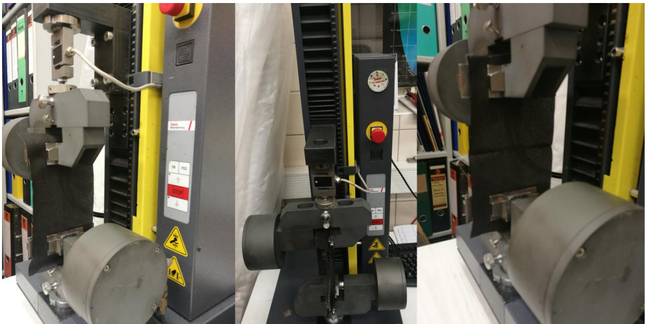
3.22 pav. Naudota įranga su bandiniais testui audinių siūlų prie siūlės atsparumo slydimui nustatymas (ISO 13936-2:2004).
