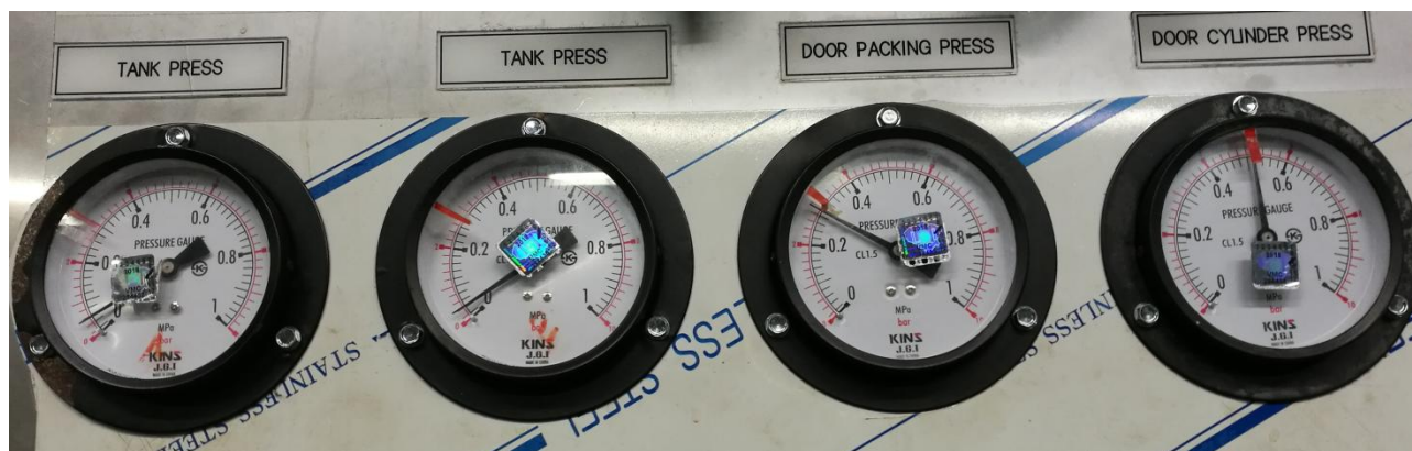
3.8 pav. Aukštatemperatūrės veleninės mašinos Sung Moo CTS- B80-900 slėgio parametrai dažymo metu
