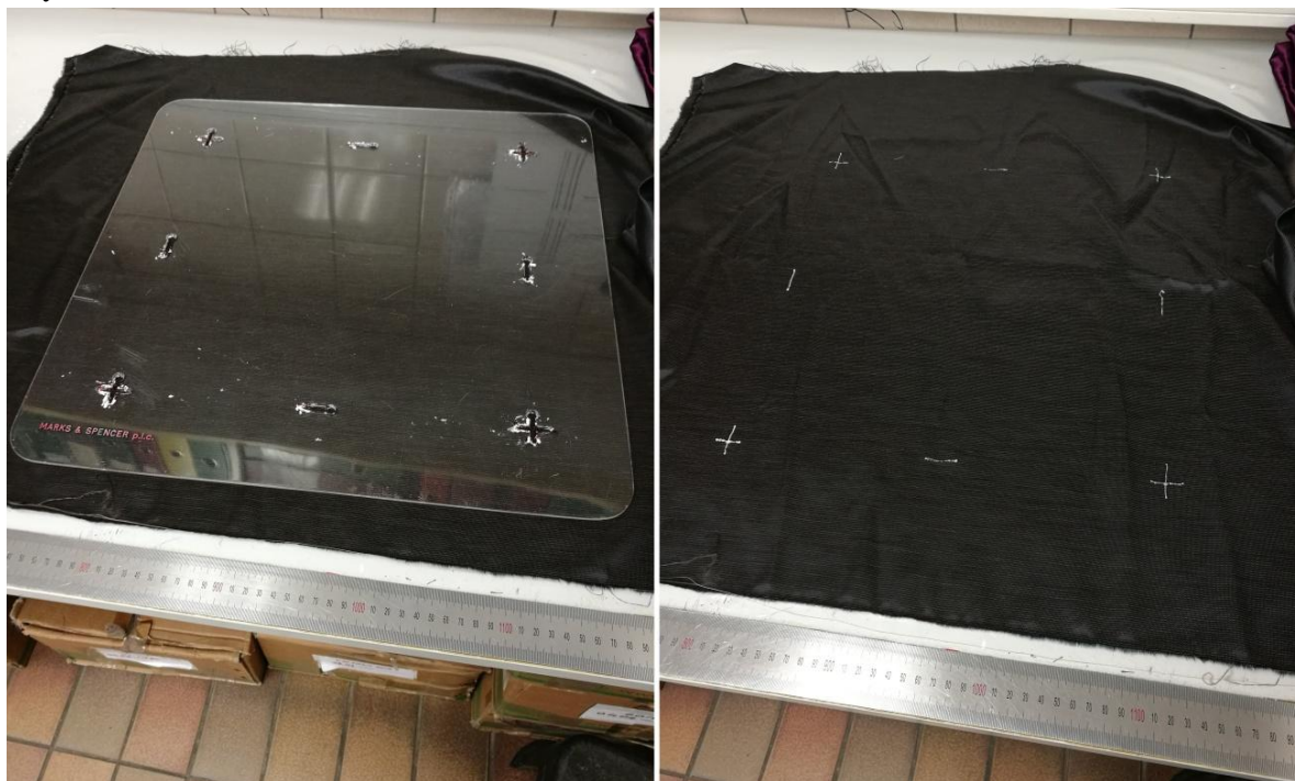
3.17 pav. Bandinių ruošimas testui buitinio skalbimo ir džiovinimo procedūros bandant tekstilę (ISO6330:2012).
