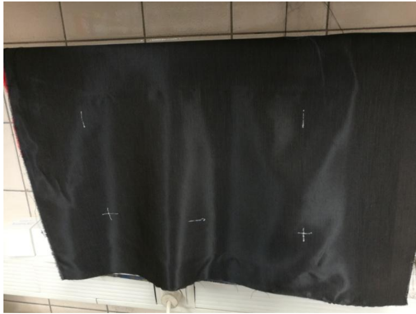
3.19 pav. Bandiniai po garinimo ir skalbimo palikti kondicinėse salygoose, prieš atliekant testą buitinio skalbimo ir džiovinimo procedūros bandant tekstilę (ISO6330:2012).
