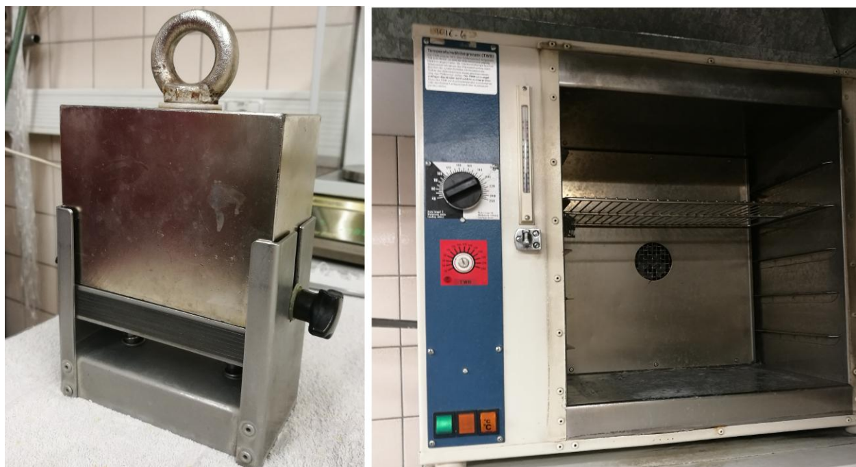
3.16 pav. Testui spalvos atsparumo prakaitui (ISO 105-E04:2013) ir spalvos atsparumo vandeniui (ISO 105-E01:2013) naudota įranga
