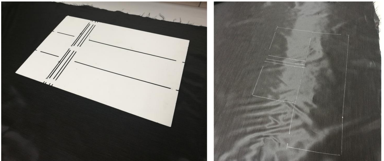
3.20 pav. Bandinių ruošimas testui audinių siūlų prie siūlės atsparumo slydimui nustatymas (ISO 13936-2:2004).
