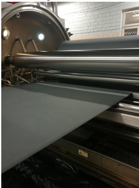
3.9 pav. Audinio iškrovimas ant kontaktinio veleno iš aukštatemperatūrės veleninės mašinos Sung Moo CTS-B80-900
