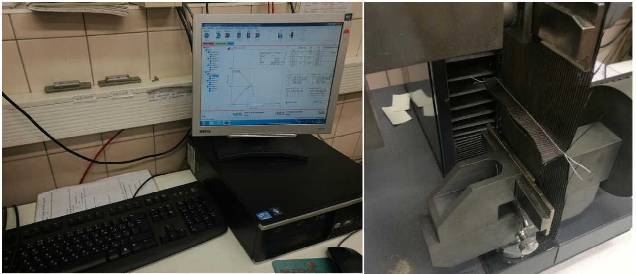
3.23 pav. Naudota įranga su bandiniais testui audinių siūlų prie siūlės atsparumo slydimui nustatymui (ISO 13936-2:2004).
