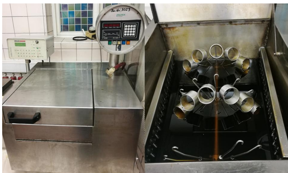
3.14 pav. Testui nusidažymo atsparumas buitiniam ir pramoniniam skalbimui (ISO 105-C06:2010) naudota įranga
