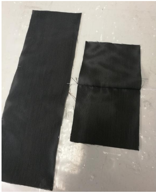
3.21 pav. Paruošti bandiniai testui audinių siūlų prie siūlės atsparumo slydimui nustatymas (ISO 13936-2:2004).
