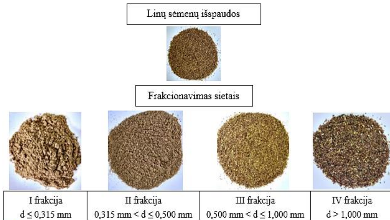
2 pav. LSI frakcijos, gautos naudojant Haver EML Digital plus ( Haver & Boecker , Vokietija) vibrosijotuvą su sietų komplektu, kurį sudaro 0,315 mm, 0,500 mm ir 1,000 mm akučių dydžio sietai
