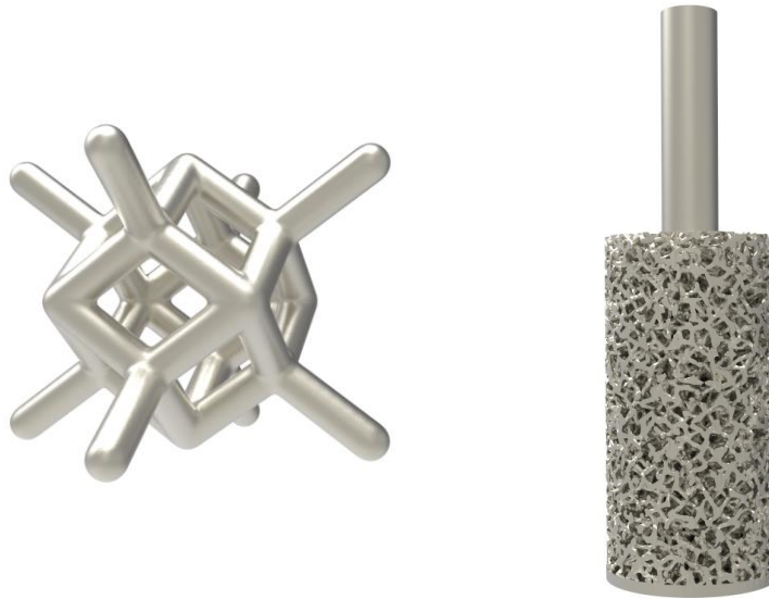
13 pav. Trabekulinė struktūra: a) struktūros celės forma – dode-thin ; b) tyrimo metu naudotos trabekulinės struktūros bandinys
