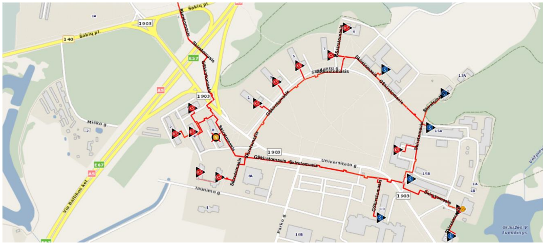
2.1 pav. Akademijos miestelio centralizuotai tiekiamos energijos šilumos tinklų schema
