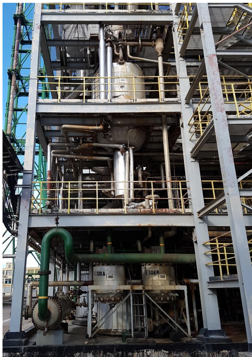
7 pav. Azoto rūgšties neutralizatorius, amonio nitrato gamybos skyriuje.
