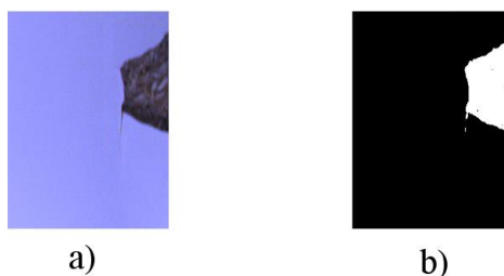
5 pav. Dvigubo slenksčio metodas. a) Matomas defektas, b) Vaizdas apdorotas dvigubo slenksčio algoritmu
