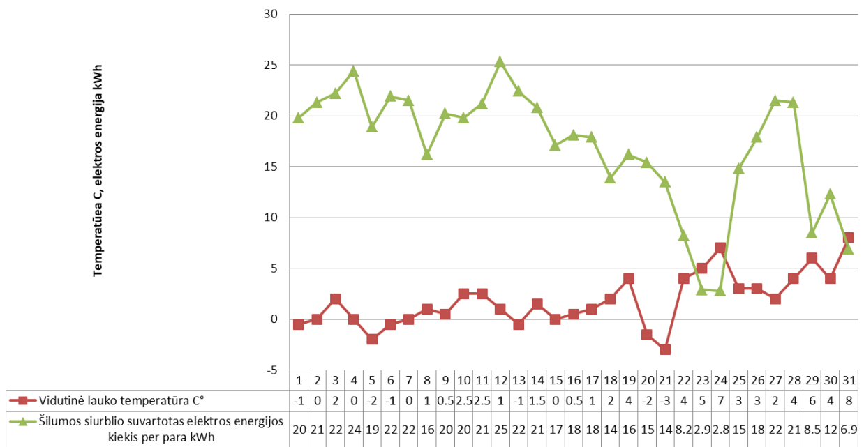
31 pav. Šilumos siurblio sunaudotos elektros energijos kiekis nuo lauko temperatūros kovo mėnesį
