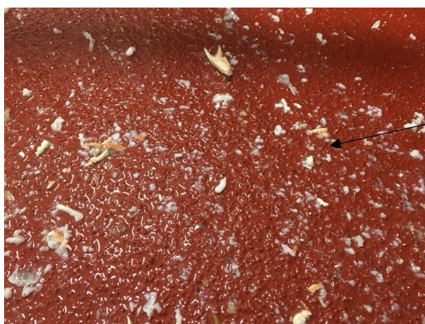
1.12 pav. Iš pasterizavimo įrenginio su kondensatu išmetamos priemaišos
