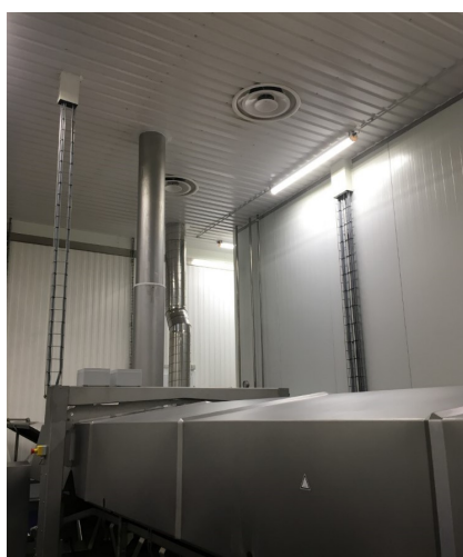
1.7 pav. Pasterizavimo įrenginys, garo išmetimo vamzdis
