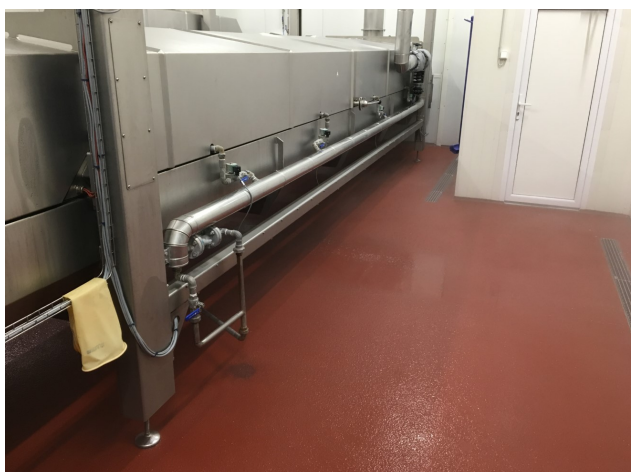
1.4 pav. Pasterizavimo įrenginys, garo linija
