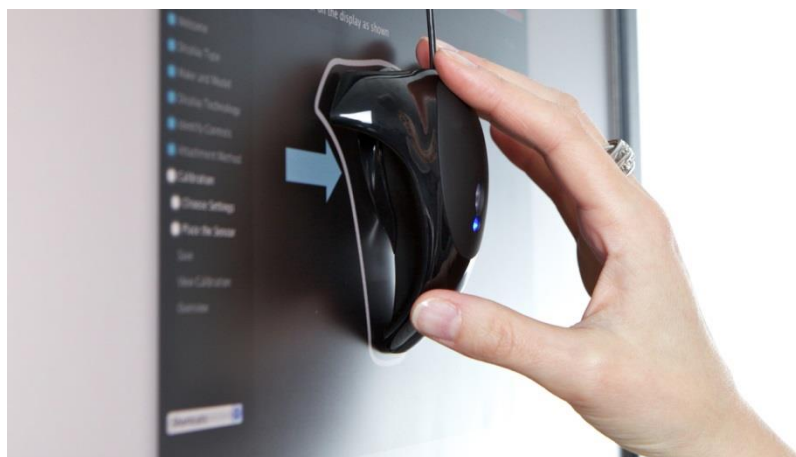
3.2 pav. Spektrofotometro naudojimas monitoriaus kalibravimui [23]
