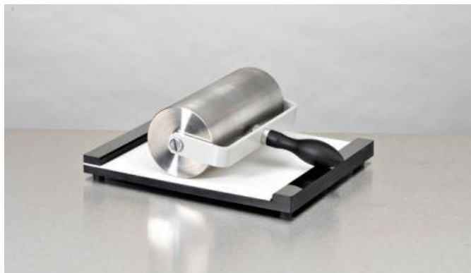
4 pav. Ritinėlis (10kg.), kuriuo nusauginamas bandinys po mirkymo vandenyje [14]
