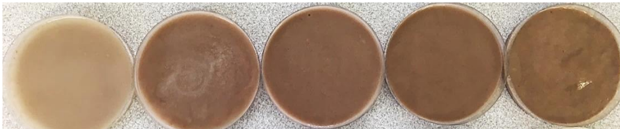
3.9 pav. BLSF geliai (3 %; 6 %; 9 %; 12 %; 15 %), gauti apdorojus mėginius 37 kHz ultragarsinėje įrangoje, 2 W/cm 2 intensyvumu, laike 30 min
