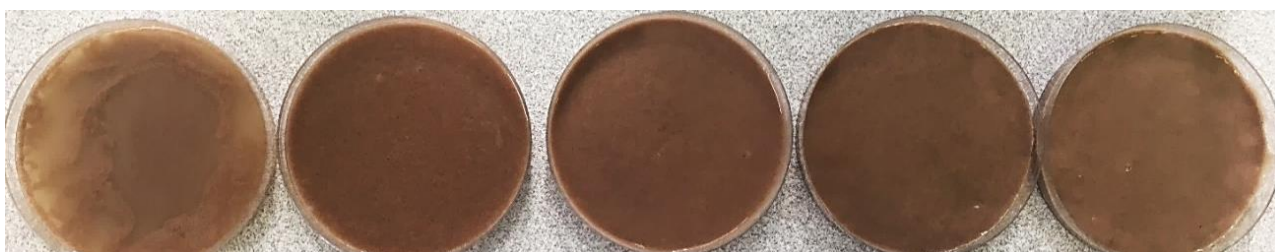
3.10 pav. BLSF geliai (3 %; 6 %; 9 %; 12 %; 15 %), gauti apdorojus mėginius 850 kHz ultragarsinėje įrangoje, 0,9 W/cm 2 intensyvumu, laike 30 min
