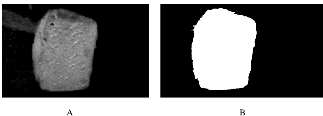
23 pav. Apdorotos nuotraukos skirtos apmokymui (A – HVS spalvų modelis, su pastebimais triukšmais, B – binarizuotas vaizdas su panaikintais triukšmais)
