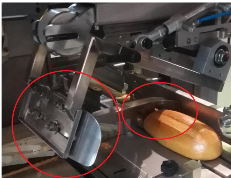
20 pav. Produktų griebtuvo ir liniuotės pritaikymas produkto formai
