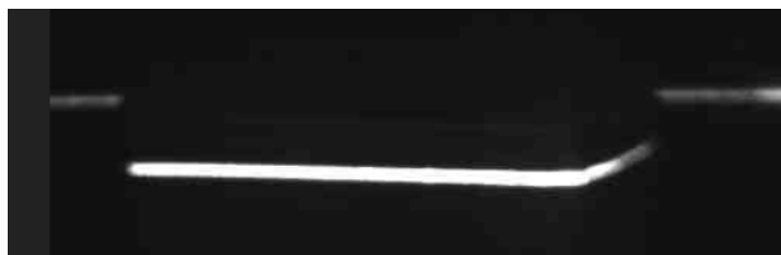
42 pav. Lazerinio 2D profilio atpažinimo jutiklio kameros daryta nuotrauka apmokymo metu
